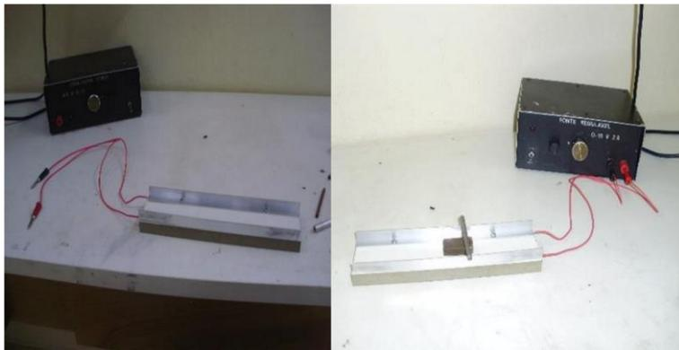
Figura A5: Base + fonte de alimentação (15 v / 2 A) + imã (neodímio) + eixo rolante.
