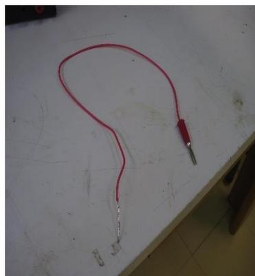
Figura A3: Fios de cobre + soquete (4mm).
