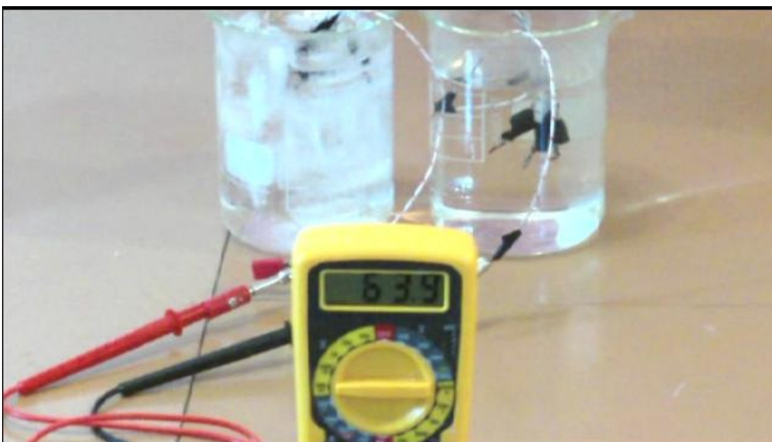
Figura 22 - Detalhe extraído do vídeo mostrando o nível de tensão nos terminais das junções metálicas em série (após estabilização).
