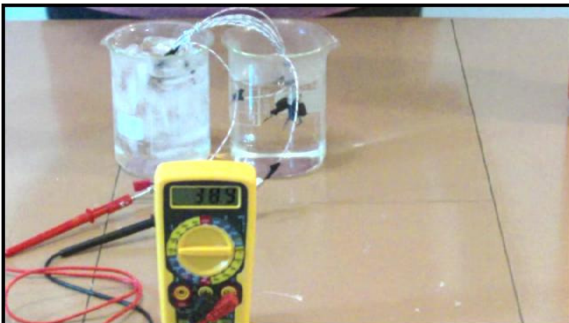
Figura 22 - Visualização extraída do vídeo gerado do Efeito Seebeck em junções metálicas em série.
