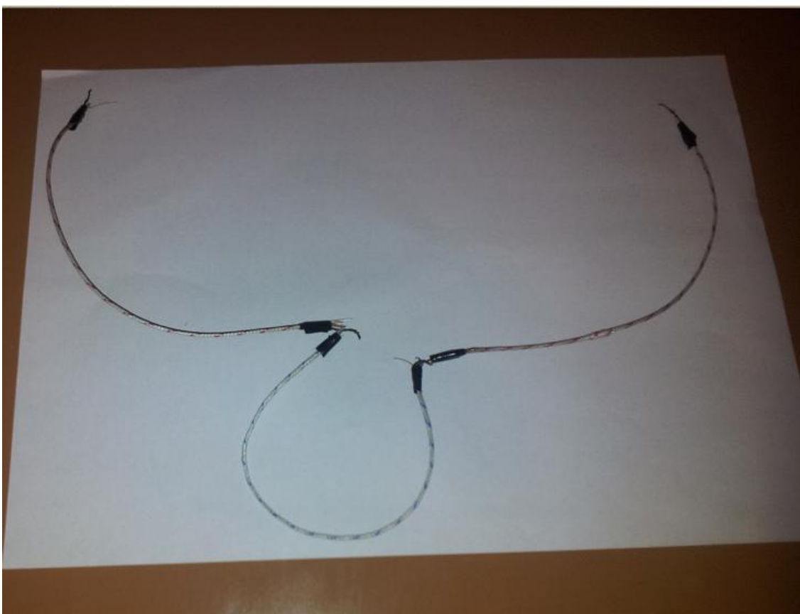
Figura 11 – Junção Ferro-Constantan conforme referência [1]
