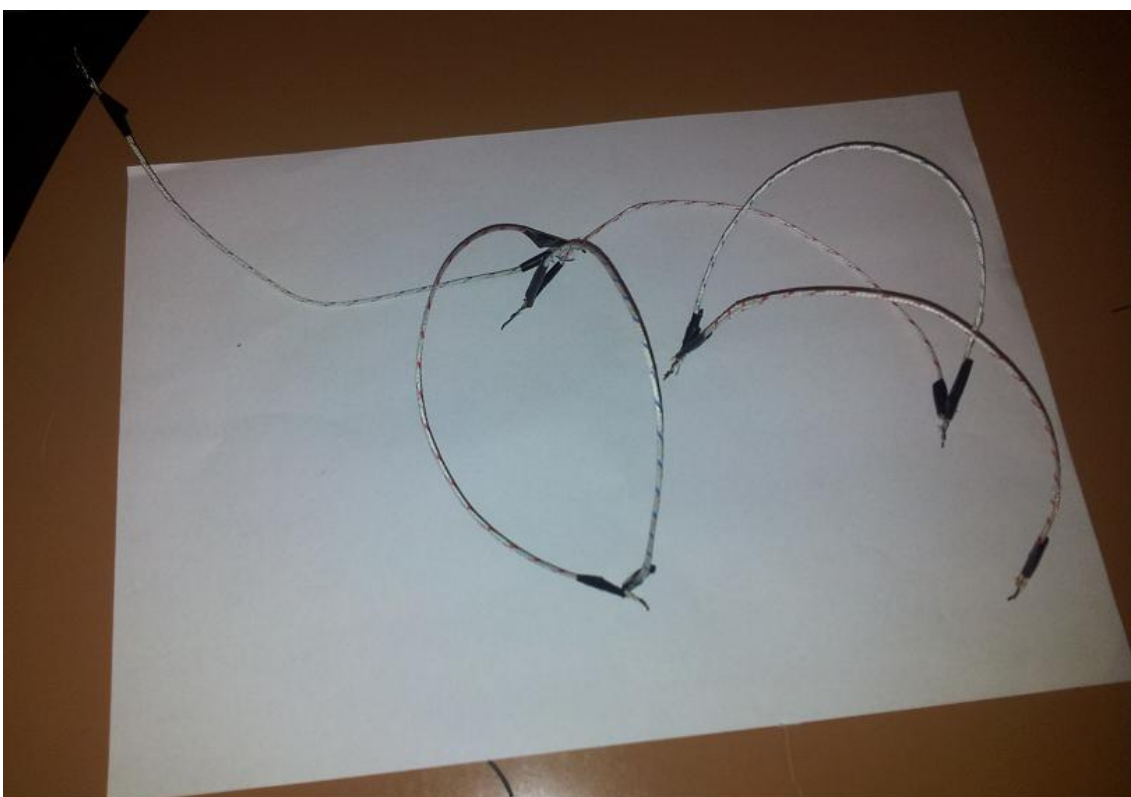
Figura 13 – Junções em série conforme referência [3]
