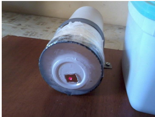
Figura 44 – Tubo e membrana mista montados para formarem a versão caseira do experimento.
