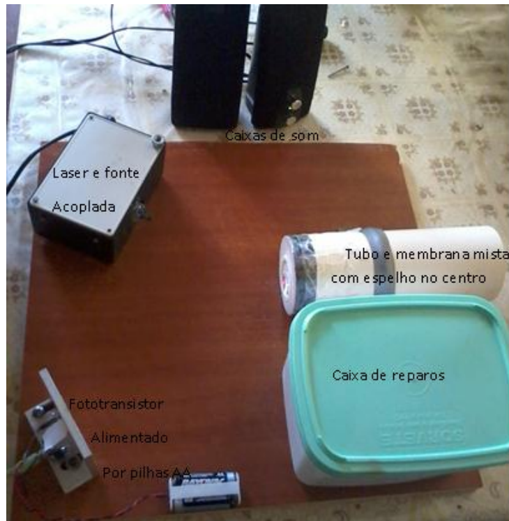
Figura 45 – Foto da montagem caseira completa, já com todos os componentes unidos a mesa de suporte e operando.
