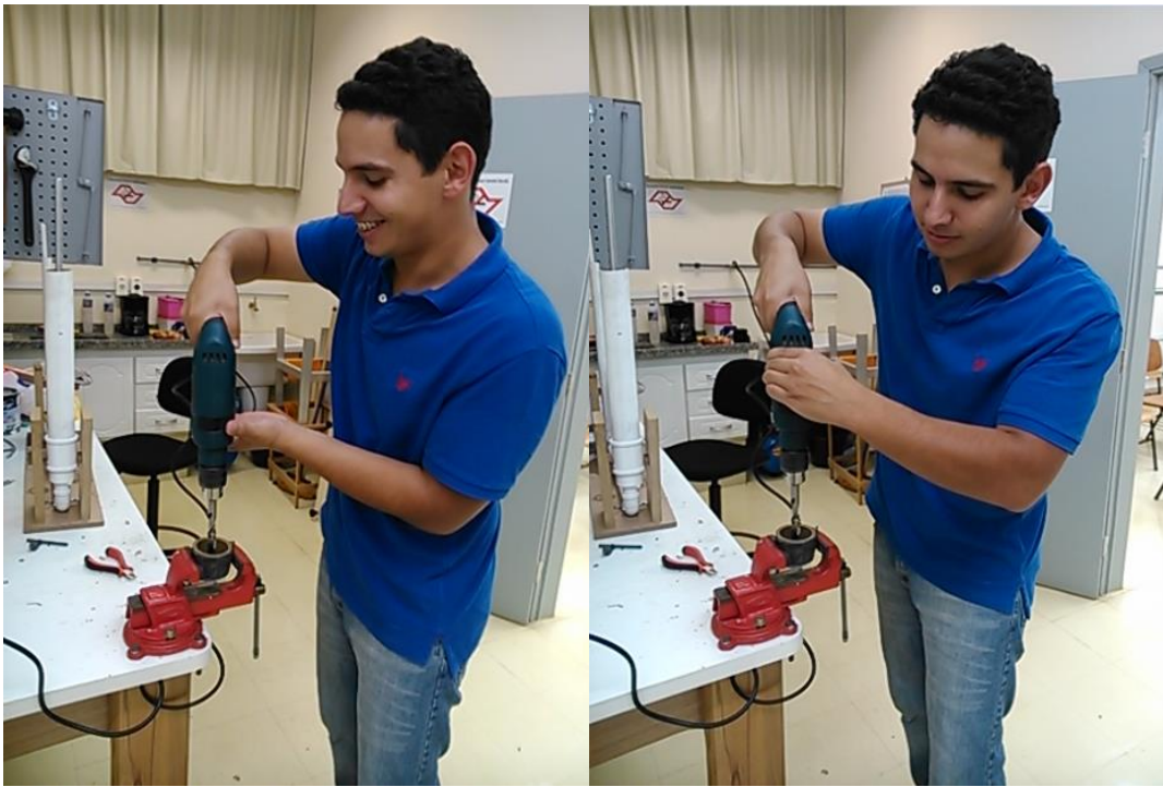
Figura 16: furando a tampa do cano para fixar no experimento
