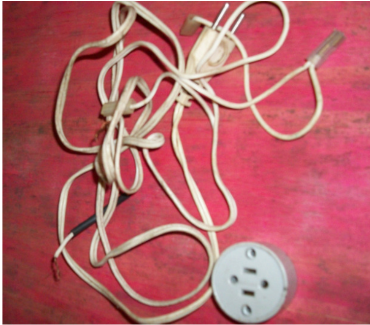
Figura 16 – Macho para conexão do fio à rede elétrica.
