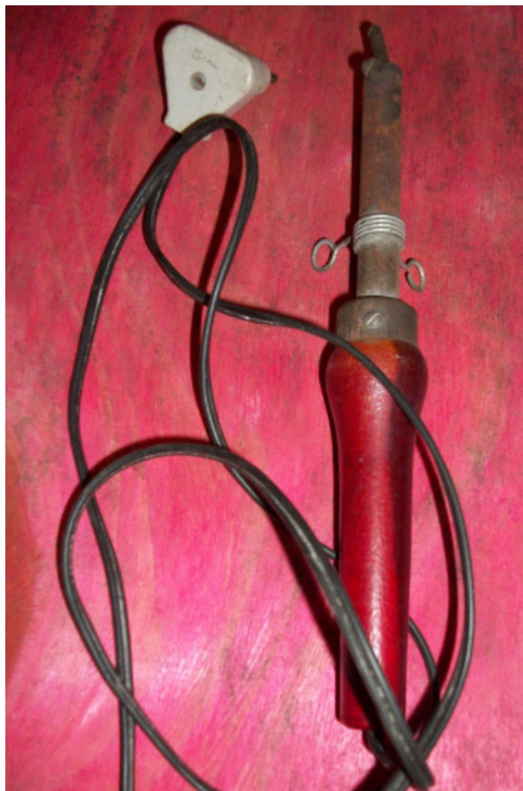
Figura 14 – Ferro de solda para soldagem dos contatos e fios elétricos.
