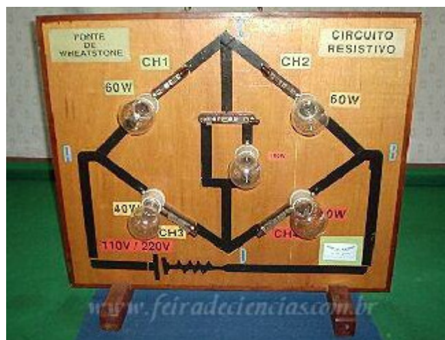
Figura 4 – Montagem elétrica da ponte de Wheatstone
