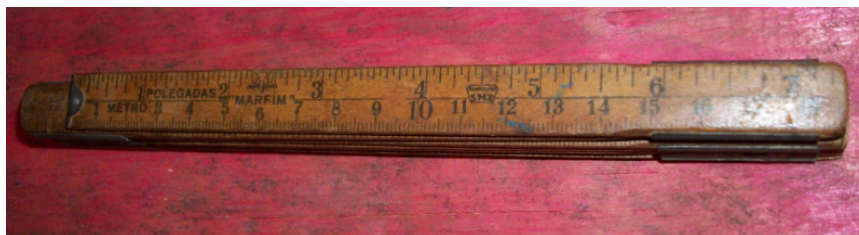
Figura 18 – Metro de madeira para tirar medidas da chapa e posicionamento do componenetes.
