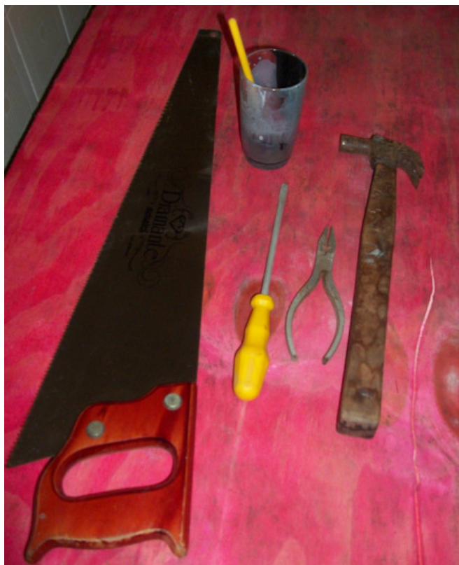
Figura 11 – Ferramentas: serra, chave de fenda, alicate, martelo e pincel para pintura do madeirite.
