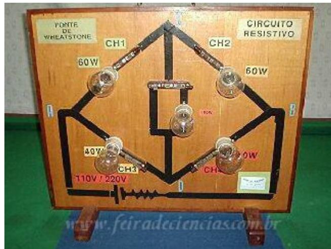
Figura 4 – Montagem elétrica da ponte de Wheatstone
