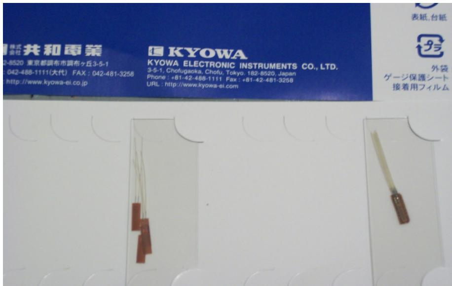
Figura 13 – Extensômetros KYOWA.
