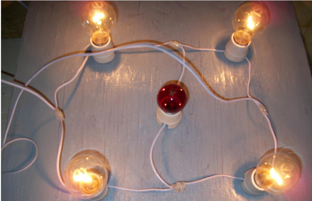
Figura 11 – Teste da ponte de Wheatstone em equilíbrio – a lâmpada do meio não acende.
