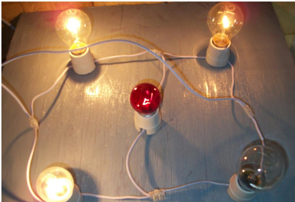
Figura 12 – Teste da ponte de Wheatstone em desequilíbrio – a lâmpada do meio acende.
