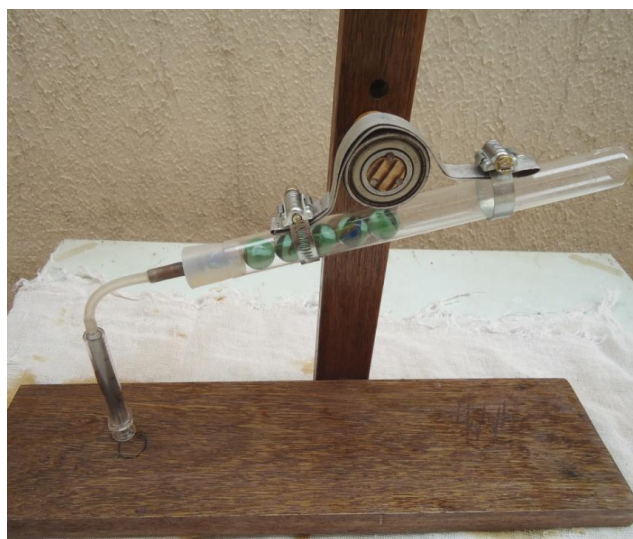
Figura 21. Motor de Stirling sem a fonte de calor
