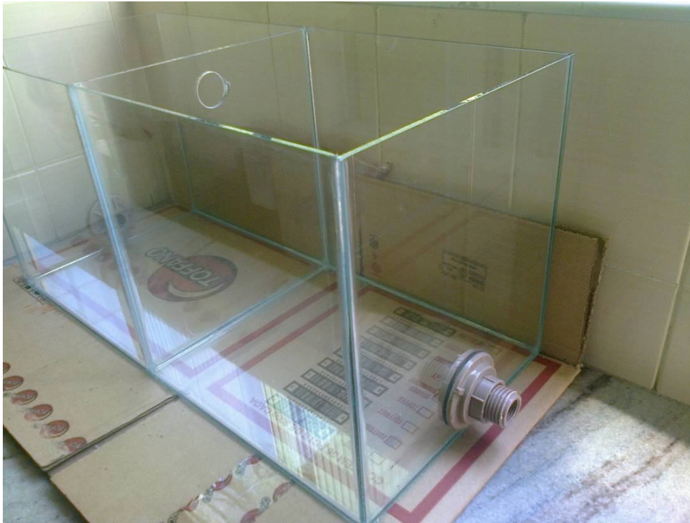
Figura 7 – Vista lateral do tanque principal. Detalhe para o flange lateral.
