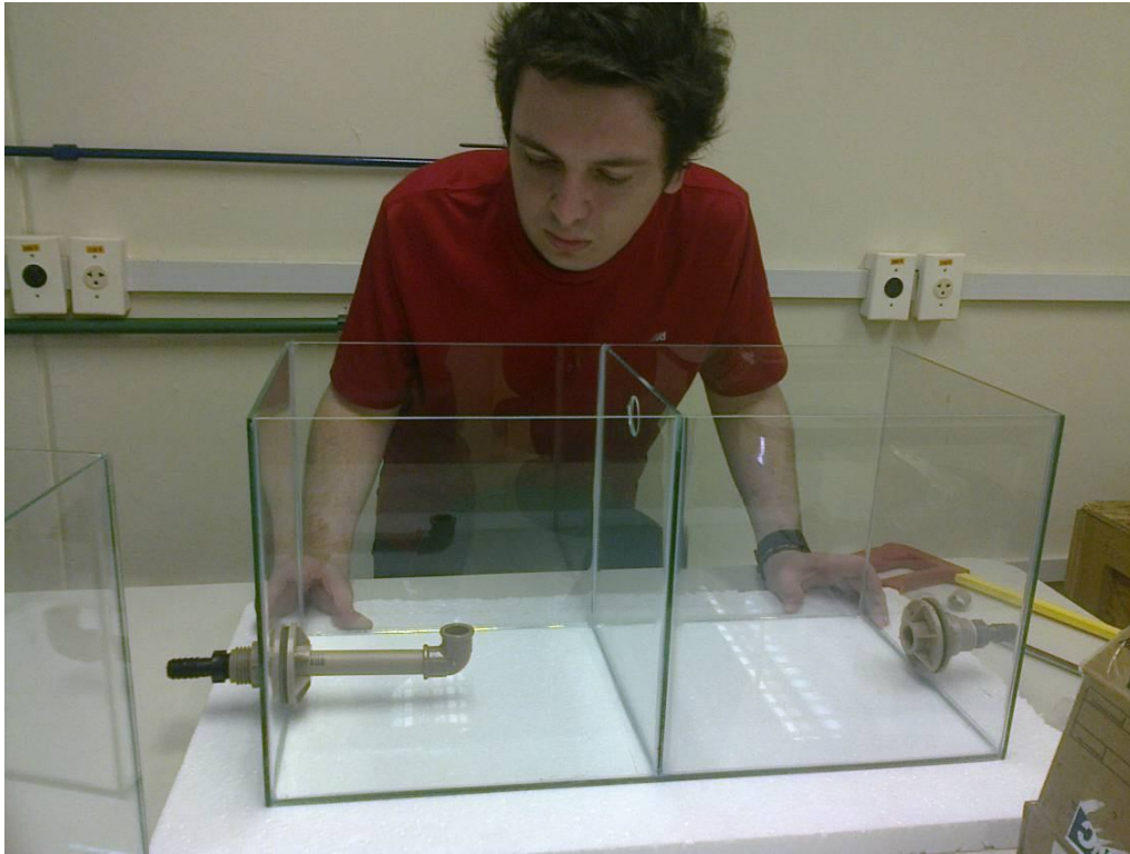
Figura 15 – Cano de direcionamento de fluxo central instalado.
