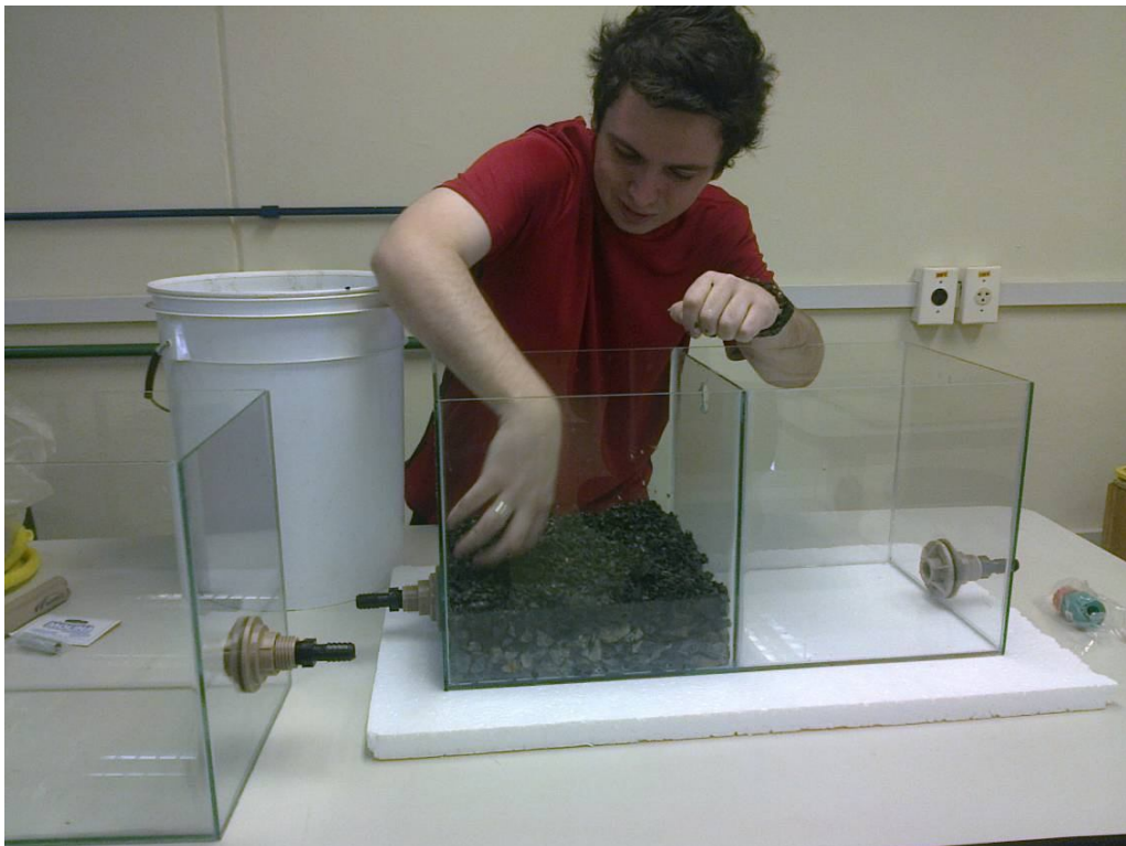
Figura 18 – Colocação das britas menores depois da lavagem.
