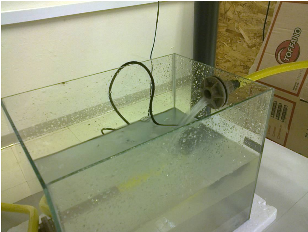
Figura 31 – Tanque de realimentação: fluxo de água vindo do tanque principal.
