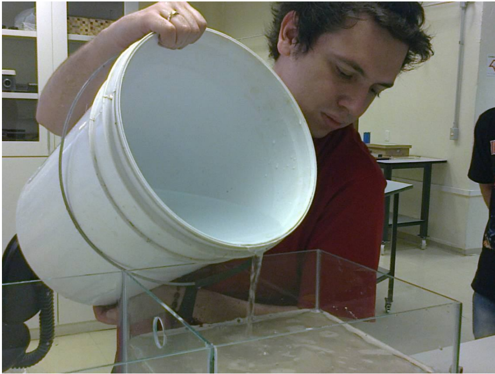
Figura 26 – Enchendo o tanque principal com água para os primeiros testes. A água estava bem turva.
