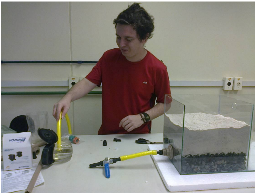
Figura 24 – Esquentando a mangueira para encaixá-la no registro.
