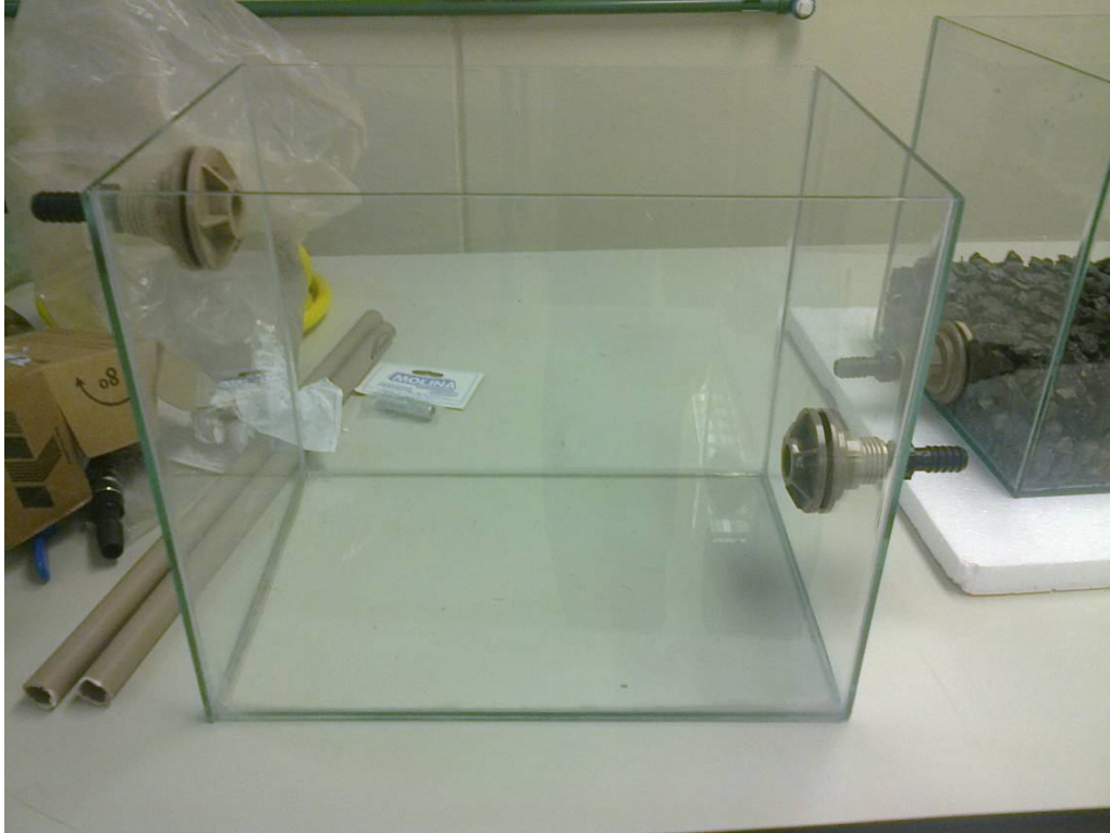
Figura 13 – Tanque de realimentação finalizado – observe que um dos flanges foi instalado na parte superior, onde ocorrerá a entrada da mangueira vinda do tanque principal.
