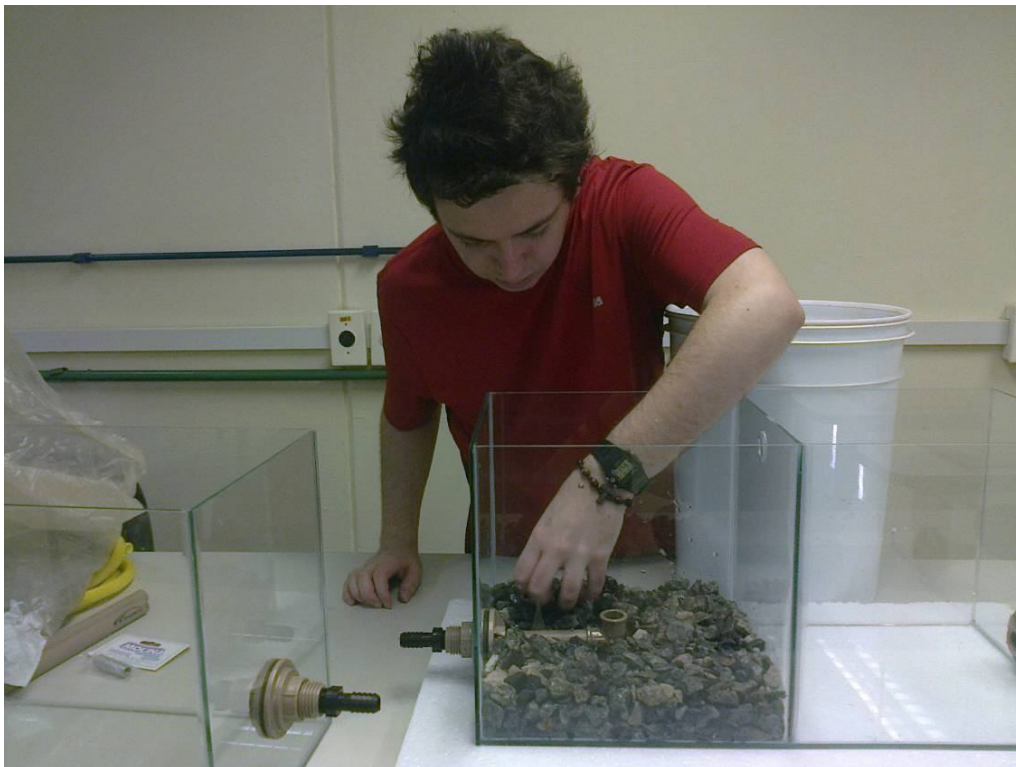
Figura 16 – Colocação das britas maiores.
