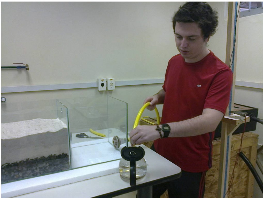
Figura 22 – Esquentando a mangueira para colocá-la no adaptador.
