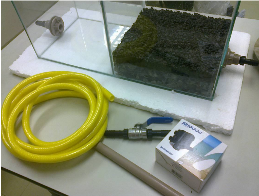
Figura 19 – Detalhe dos materiais utilizados: mangueira, registro, adaptador de mangueira, cano e bomba de aquário de 1000 L/h, além do tanque principal ao fundo.
