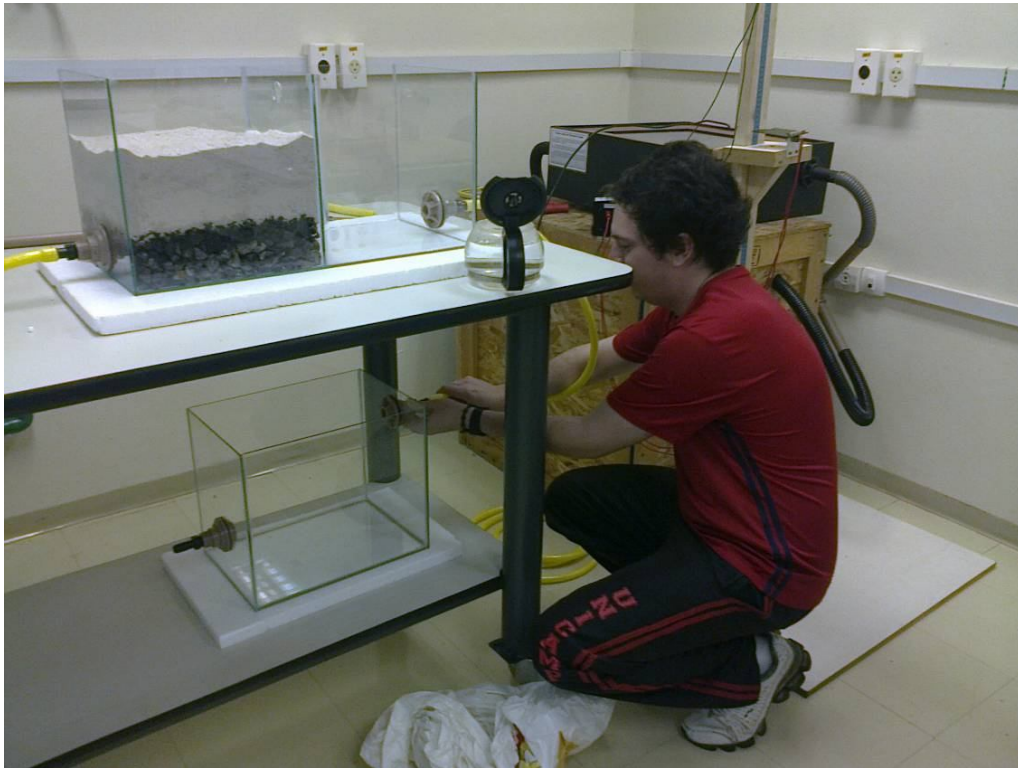
Figura 23 – Encaixe da mangueira no tanque de realimentação.
