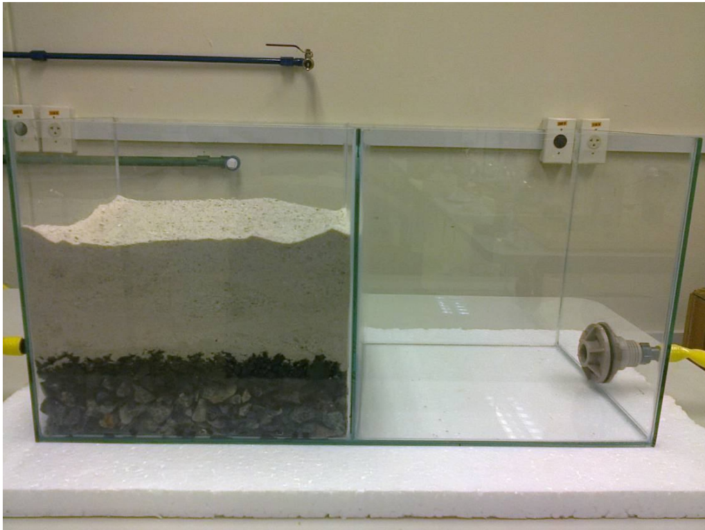
Figura 21 – A colocação da areia foi finalizada.
