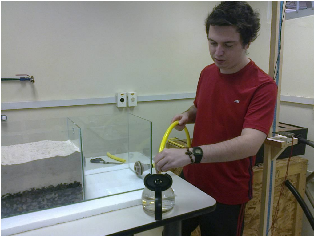
Figura 18 – esquentando a mangueira para colocá-la no adaptador.
