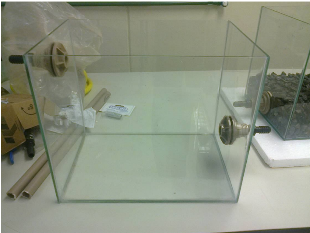
Figura 9 – Tanque de realimentação finalizado – observe que um dos flanges foi instalado na parte superior, onde ocorrerá a entrada da mangueira vinda do tanque principal.
