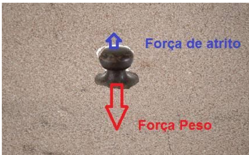
Figura 37 – Quando o atrito entre os grãos diminui drasticamente, o pesinho afunda, já que a componente desta força se mantém inalterada.
