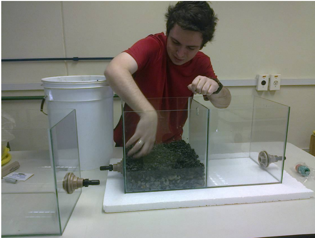
Figura 14 – Colocação das britas menores depois da lavagem.
