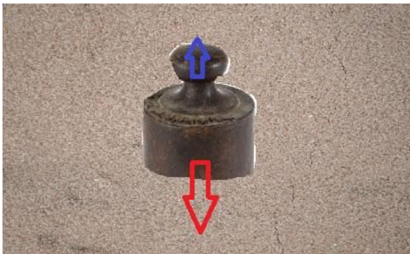
Figura 36 – A força de atrito está diminuindo devido à percolação de água de baixo para cima. A componente Peso se mantém inalterada.
