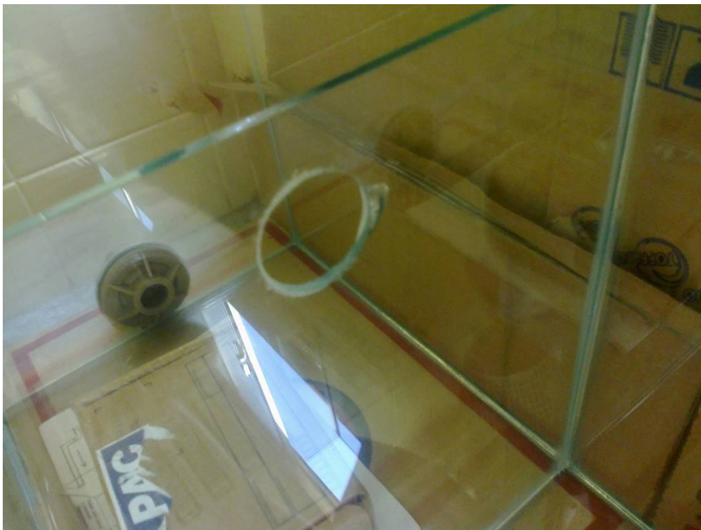
Figura 7 – Abertura superior na divisória do tanque principal para a vazão de água.
