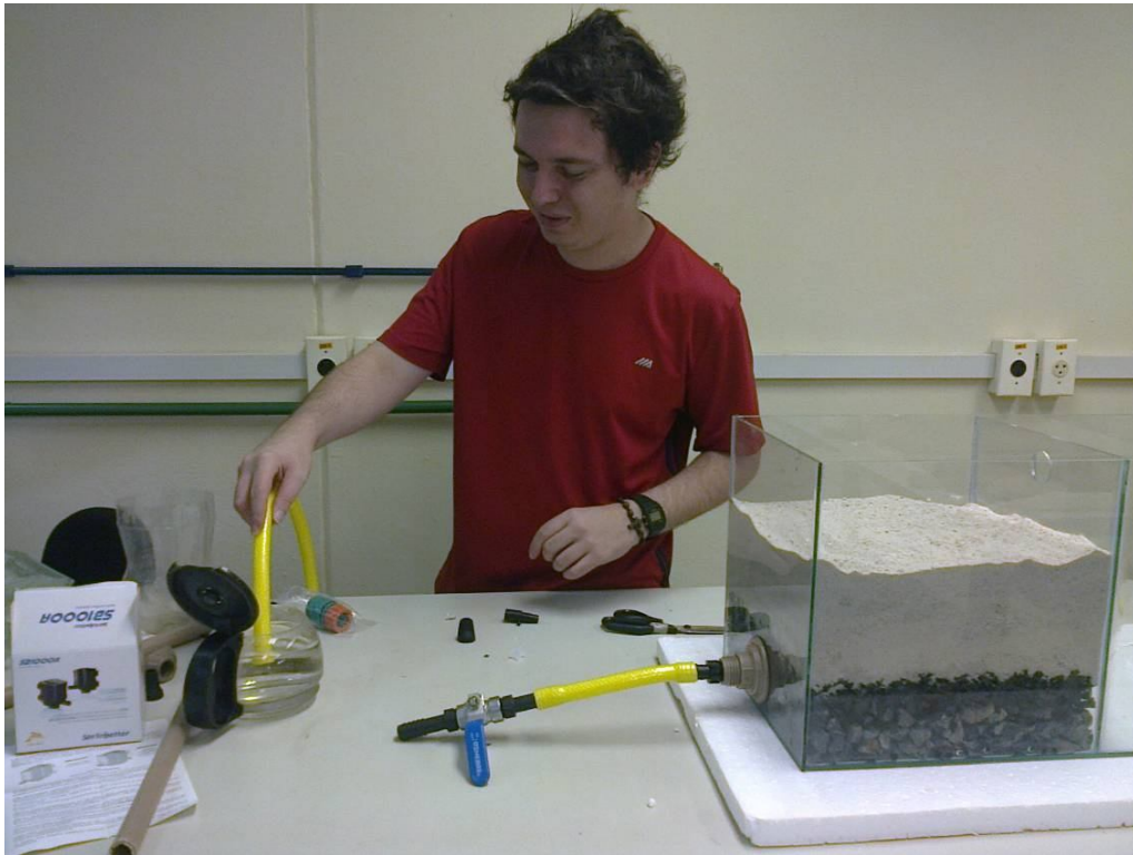
Figura 20 – Esquentando a mangueira para encaixá-la no registro.
