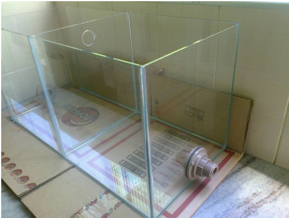
Figura 3 – Vista lateral do tanque principal. Detalhe para o flange lateral.
