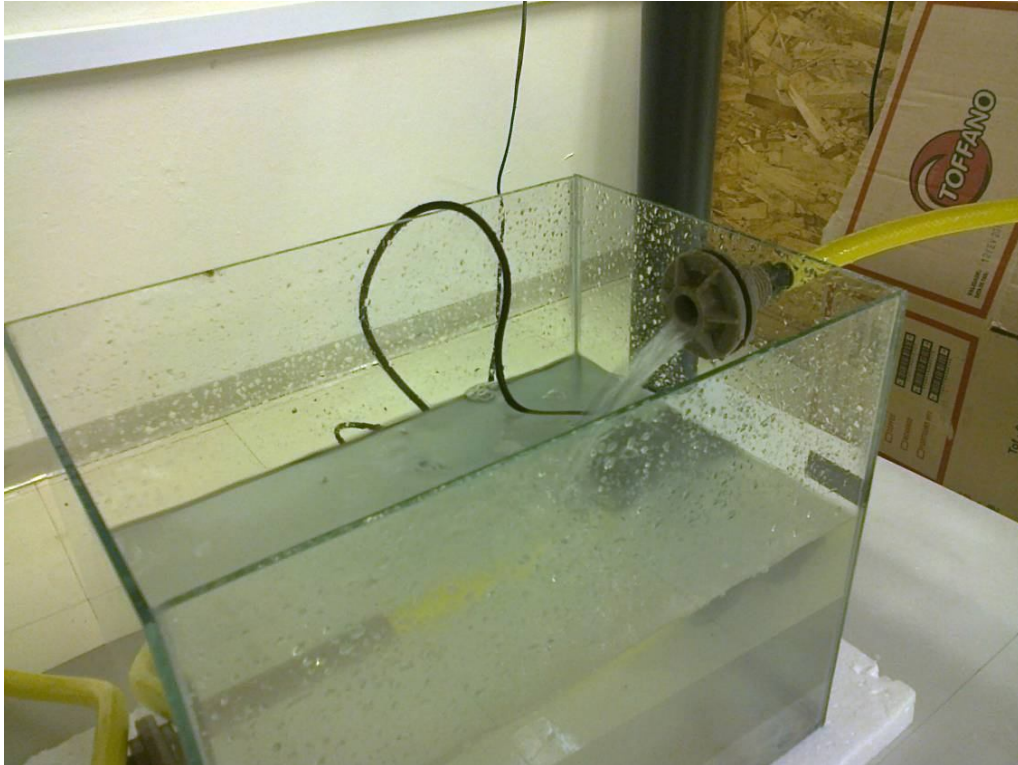
Figura 27 – Tanque de realimentação: fluxo de água vindo do tanque principal.
