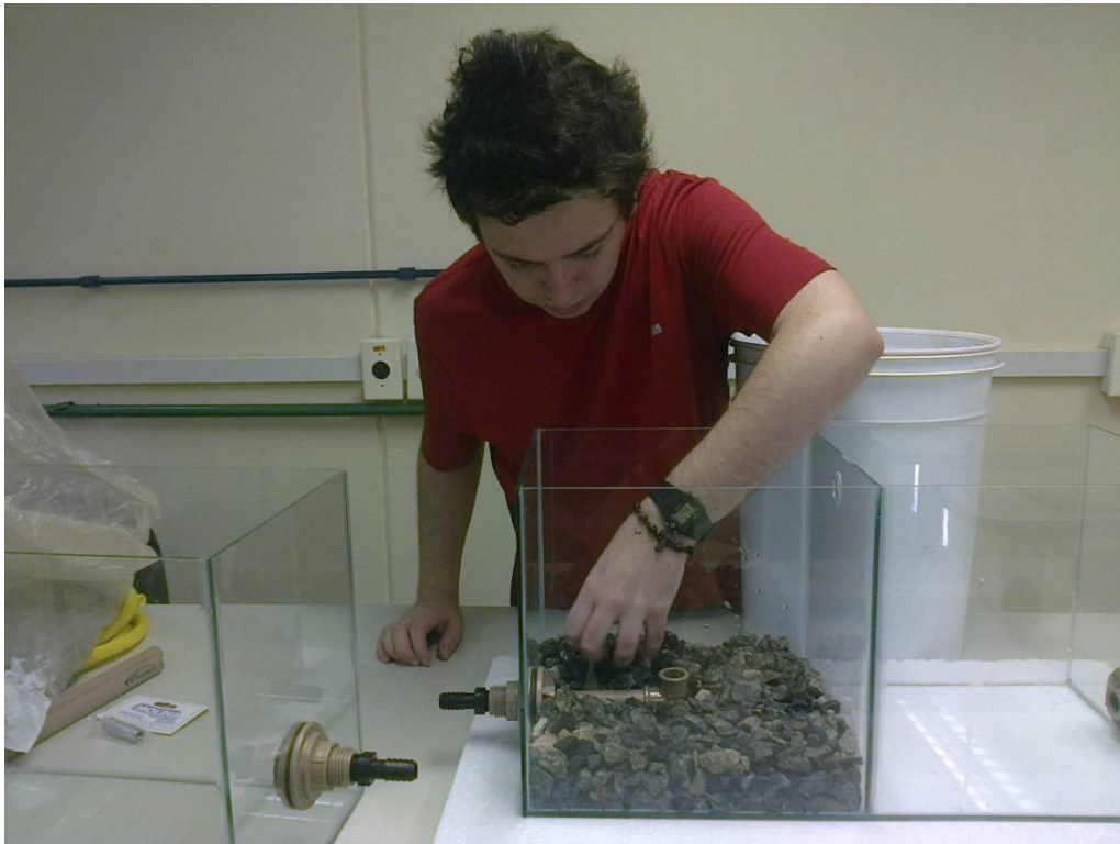
Figura 12 – Colocação das britas maiores.
