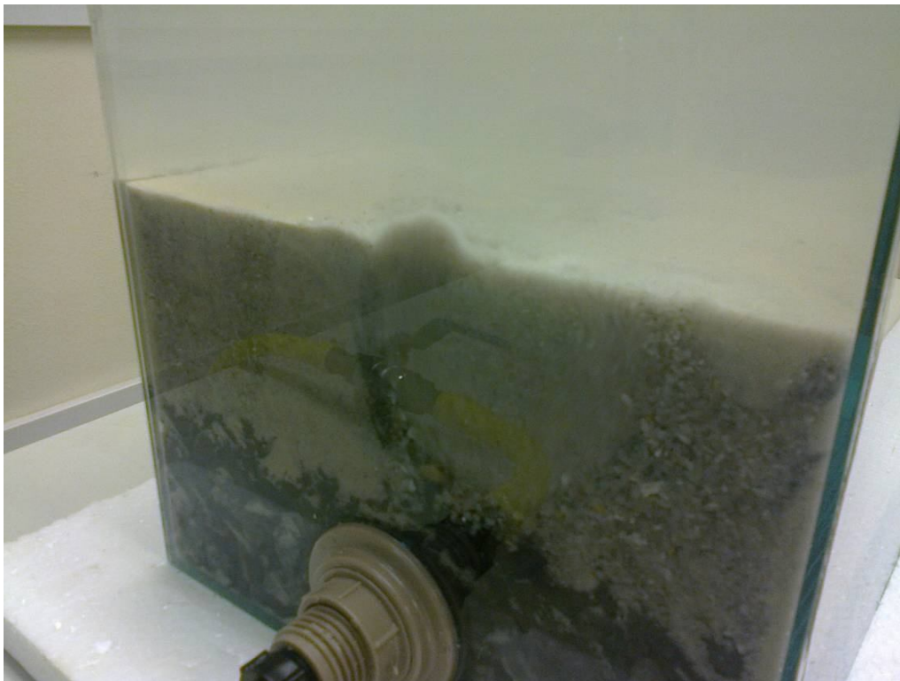
Figura 25 – Primeiros sinais de ocorrência de areia movediça na região lateral.
