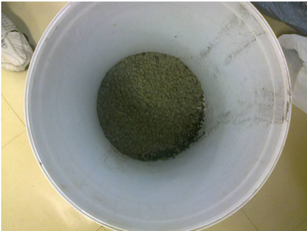
Figura 13 – Britas menores antes da lavagem.
