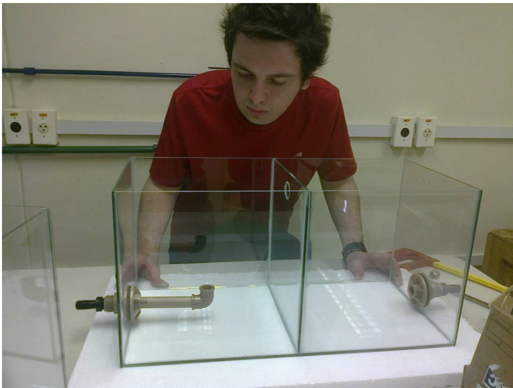
Figura 11 – Cano de direcionamento de fluxo central instalado.
