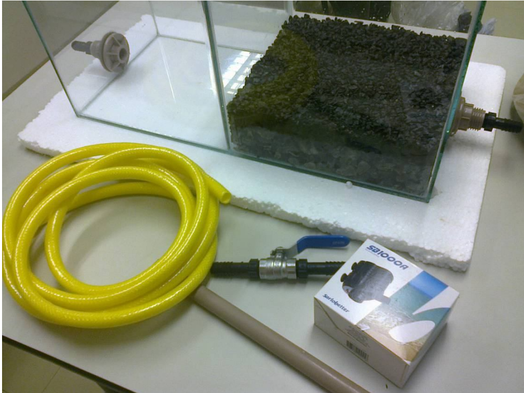
Figura 15 – Detalhe dos materiais utilizados: mangueira, registro, adaptador de mangueira, cano e bomba de aquário de 1000 L/h, além do tanque principal ao fundo.
