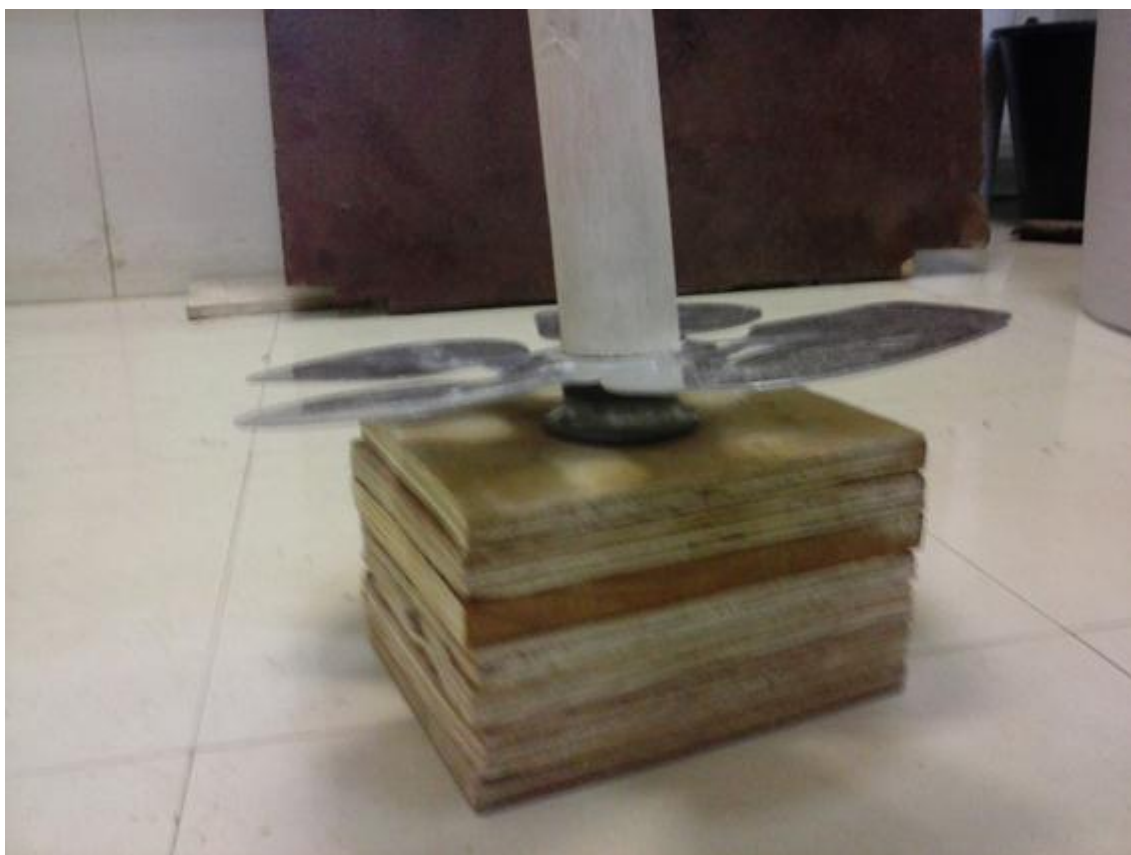
Figura 4: Acoplados, eixo, hélice e rolamento no suporte apoio.
