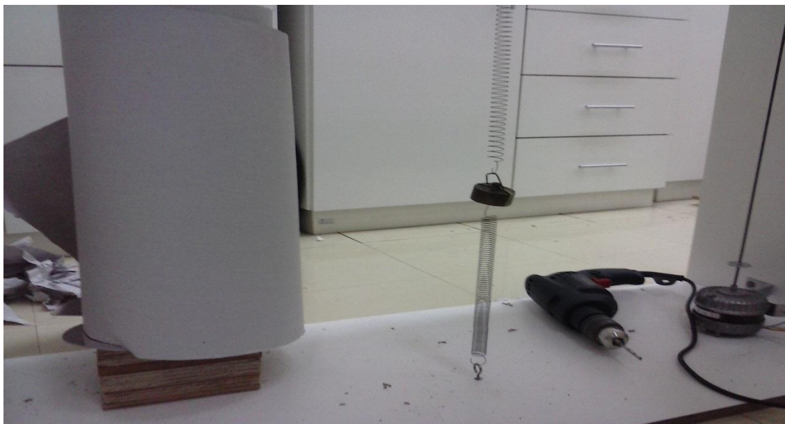
Figura 5: Mesa com a montagem, bobina a esquerda, molas presas nos ganchos, motor preso a direita com o eixo em o papel será enrolado e furadeira.
