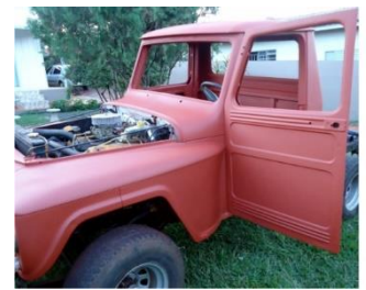
Figura 20: Aplicação de zarcão sobre superfície metálica
