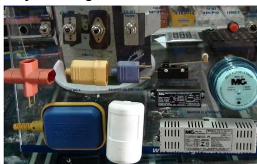
Figura 30: Plugues, reator, sensor de presença, reles fotossensíveis e acionadores
