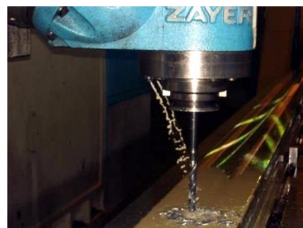
Figura 6: Furadeira de metal com líquido de arrefecimento
