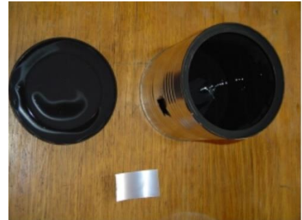
Figura 36: Lata para fotografia "pin hole" revestida com tinta preta fosca
