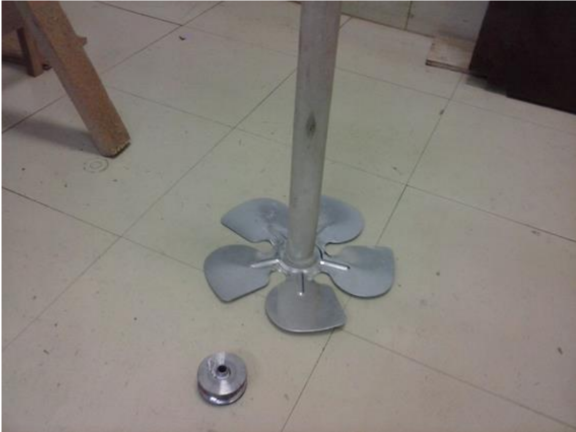
Figura 3: Rolamento, eixo feito de cabo de enxada para encaixar a bobina de papel e hélice de apoio.
