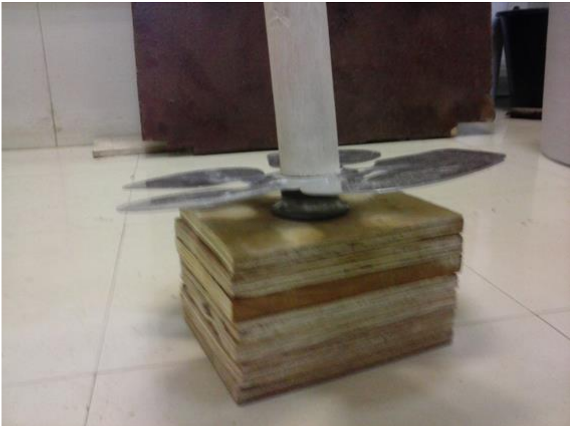
Figura 3: Rolamento, eixo feito de cabo de enxada para encaixar a bobina de papel e hélice de apoio.
