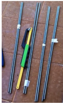
Figura 4: barras de metal que serão utilizadas no experimento acopladas aos cilindros da figura 3, junto com a serra usada para cortá-las ao meio.
