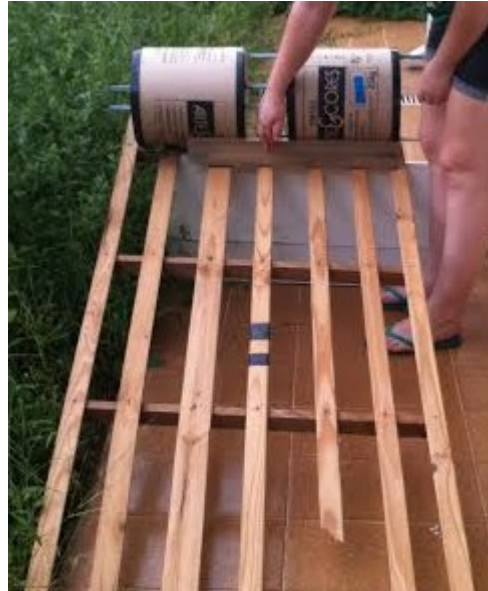
Figura 5: foto da rampa onde os cilindros deslizarão, feita com madeira de um estrado de cama.
