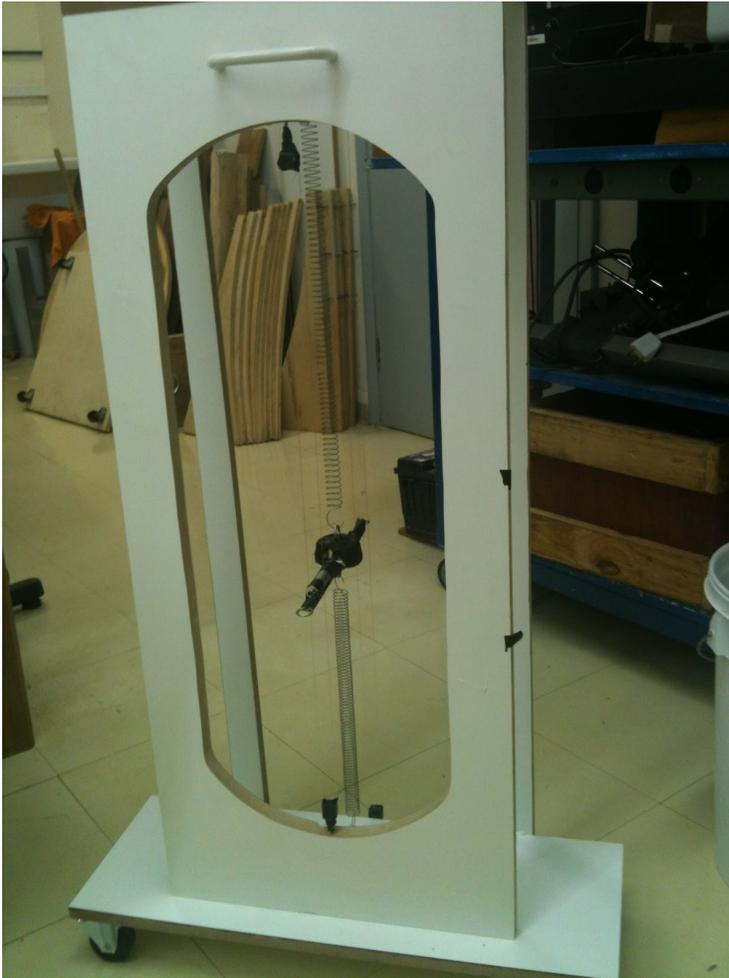
Figura 21 - Suporte formado pelo carro e a fonte de luz em sua própria estrutura acoplada ao suporte por duas molas.
