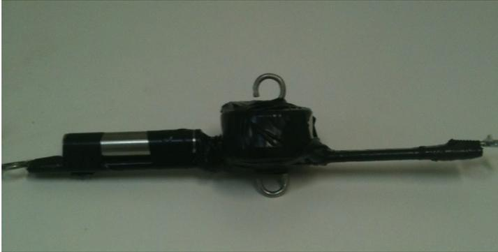
Figura 19 - Montagem parcial da estrutura de suporte da fonte de luz (apontador laser) composta por dois ganchos presos junto a um peso cilíndrico metálico no centro, e tendo *hashis* como base e dois ganchos em cada ponta, tudo unido por fita adesiva.
