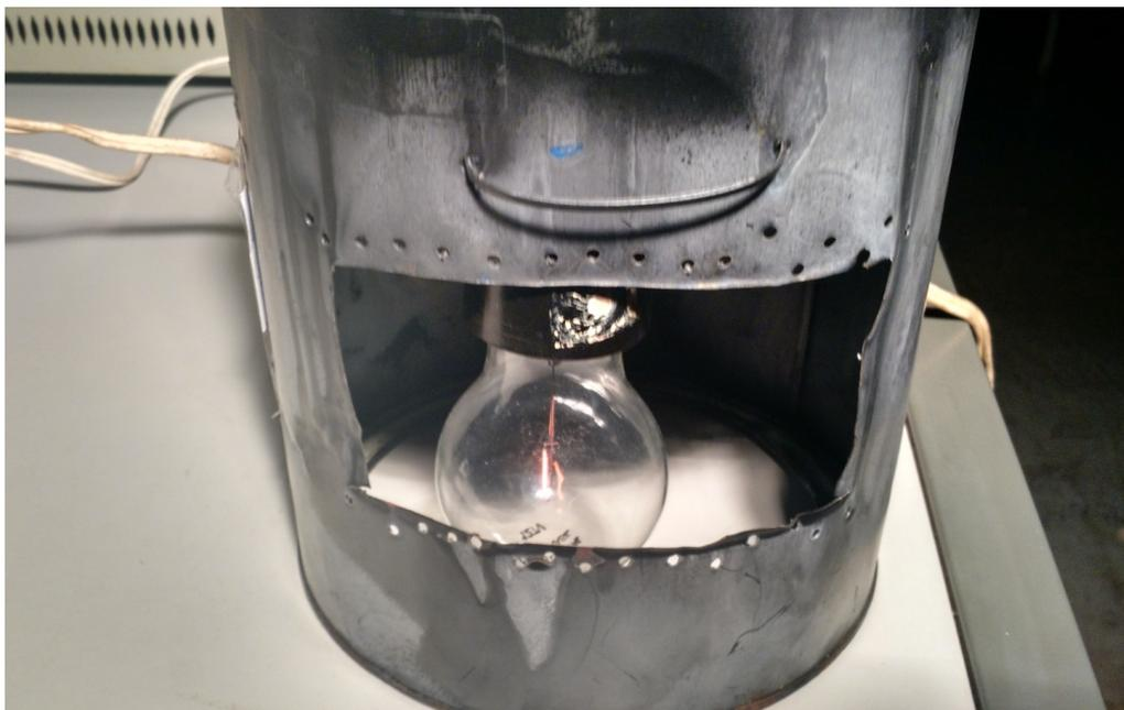
Figura 1: Foto do Experimento “Sombra de grande divergência”, nesta foto notamos o filamento da lâmpada perpendicular ao plano da foto. Este experimento foi melhorado, colocando-o em uma base inclinada para que a sombra fosse projetada por um foco pontual de luz.
