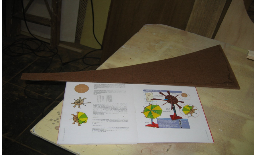
Figura 7. Molde da estrutura de sustentação feita em eucatex.
