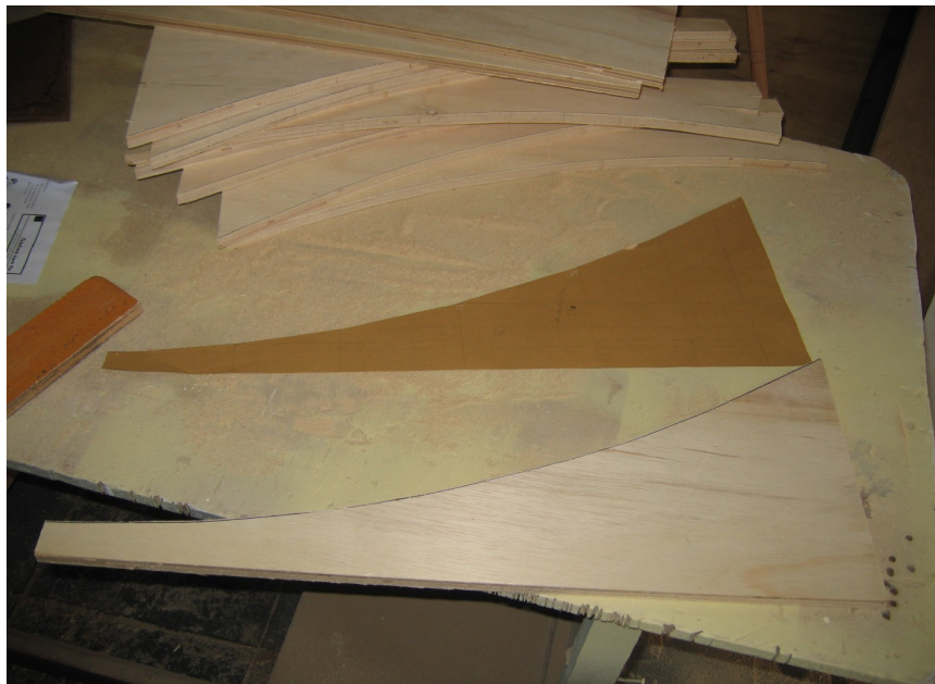
Figura 8. Estrutura de sustentação do espelho acústico parabólico.
