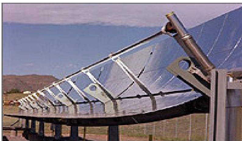
Figura 2. Espelhos parabólicos utilizados em usinas solares.
