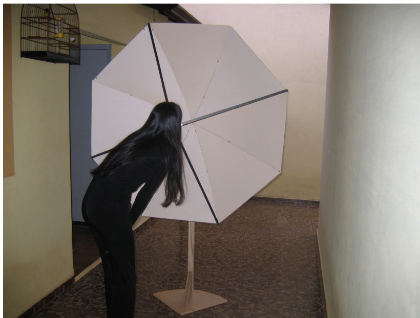
Figura 18. Espelho acústico parabólico em funcionamento.
