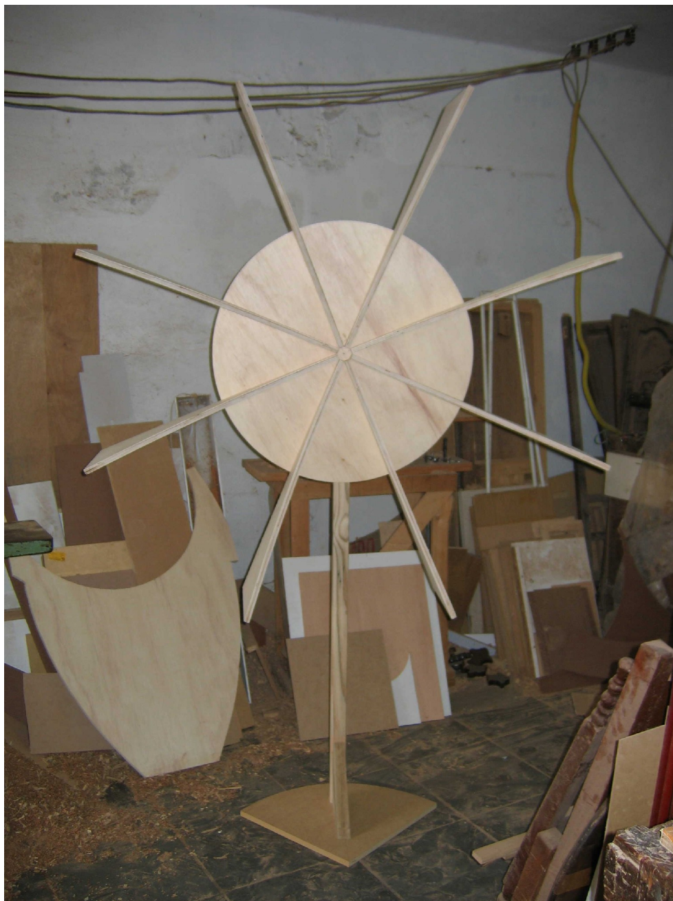
Figura 13. Espelho acústico parabólico montado no pedestal.
