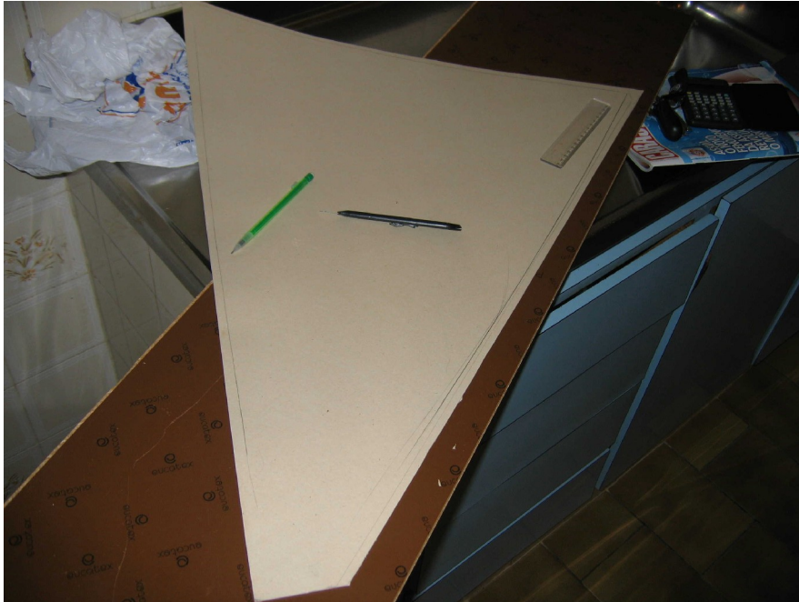
Figura 15. Corte do papel Paraná que será utilizado no espelho acústico parabólico.
