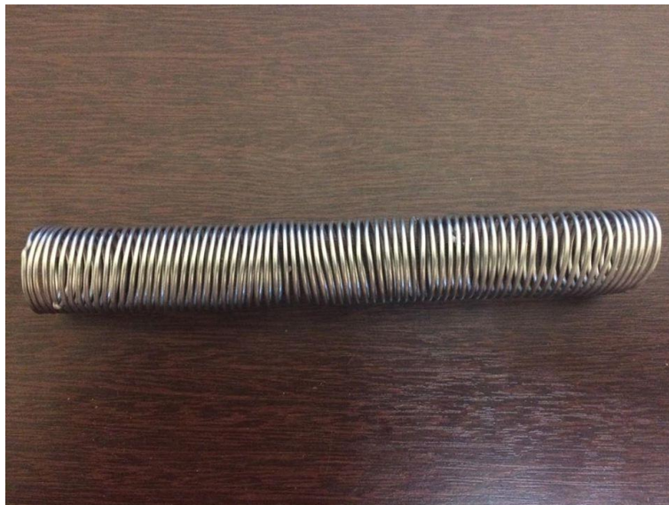
Figura 4: Exemplo de trilho enrolado no formato de uma solenoide
