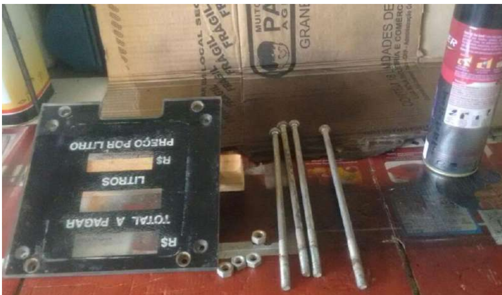
Figura 1. Materiais utilizados: placa de acrílico (visor reciclado de bomba de combustível), porcas, parafusos e tinta spray preta.
