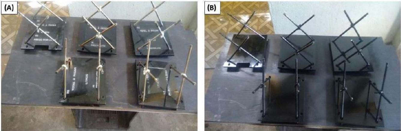
Figura 4. (A) suportes preparados pré-finalizados, (B) suportes finalizados após pintura com tinta spray preta.
