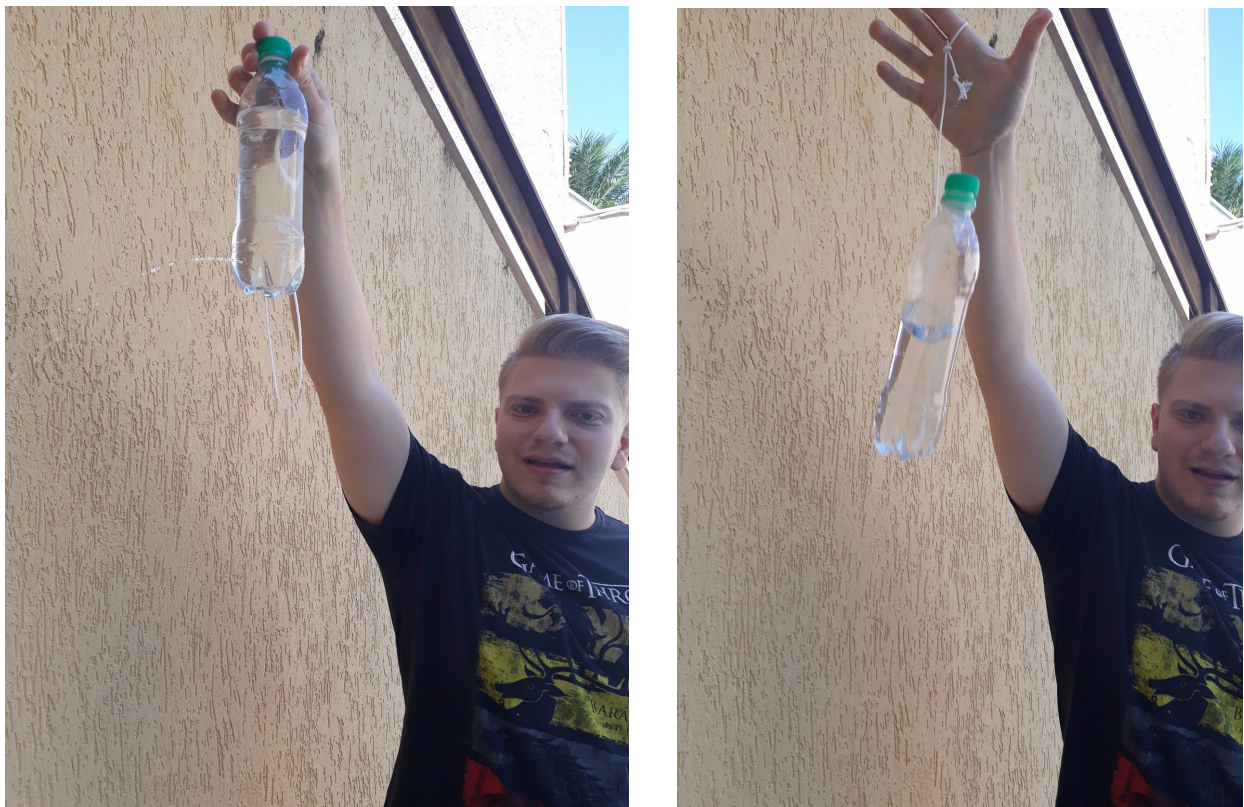
Figura 6 - Garrafa vazando em repouso. Em seguida, imagem da queda livre, onde o vazamento cessa.
