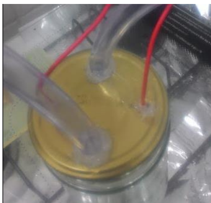
Fig. 1: pote 1, mangueiras 1 e 2 para os gases e fios vermelhos para a lâmpada
