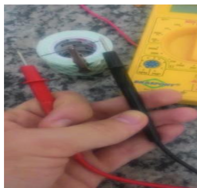
Fig. 16 – medindo a resistência dos grafites
