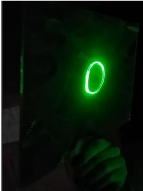
Figura 12: Espelho plano usado para refletir o cone de luz de volta ao espelho côncavo
