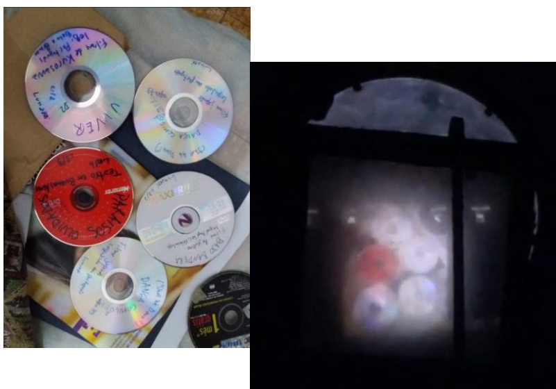
Figura 14: Esquerda: Caixa de CDs utilizada como objeto do experimento Direita: Imagem real da caixa de CDs focalizada no anteparo à frente do espelho
