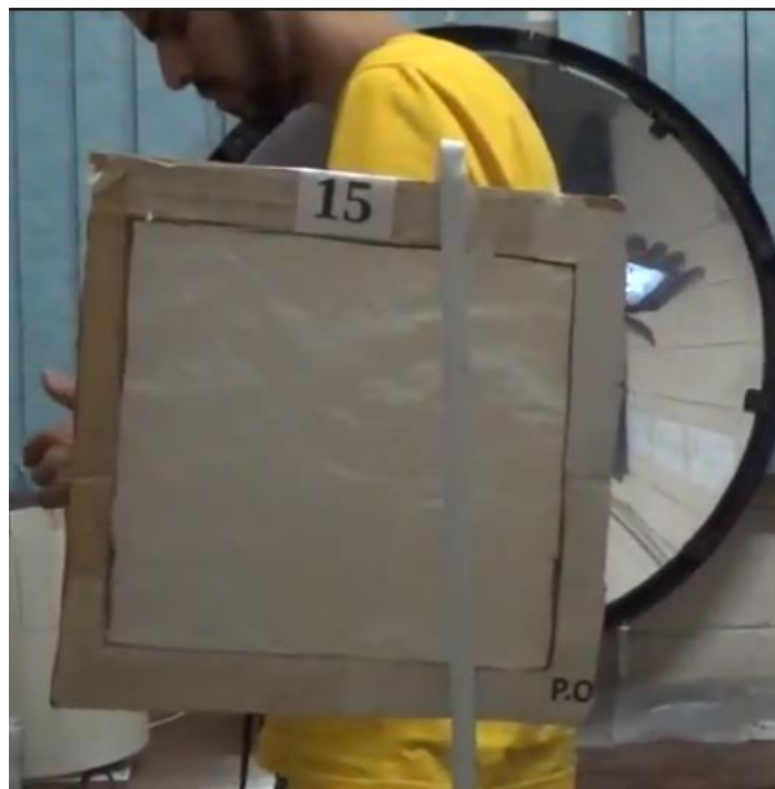
Figura 13: Anteparo utilizado para focalizar a imagem refletida
