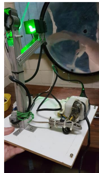
Figura 10: Raio incidindo paralelamente ao eixo do espelho e sendo refletido de forma a atravessar o foco
