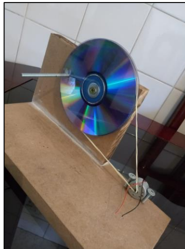
Figura 2 – Gerador elétrico feito com sucata.
