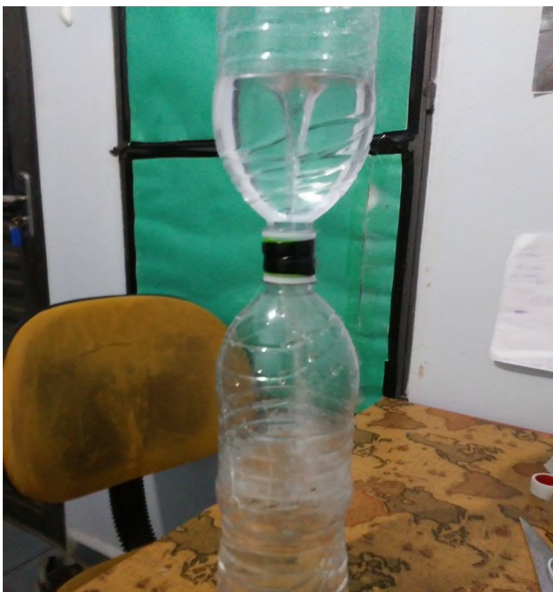
Figura 7: Conexão da transmissão de água e de ar.
