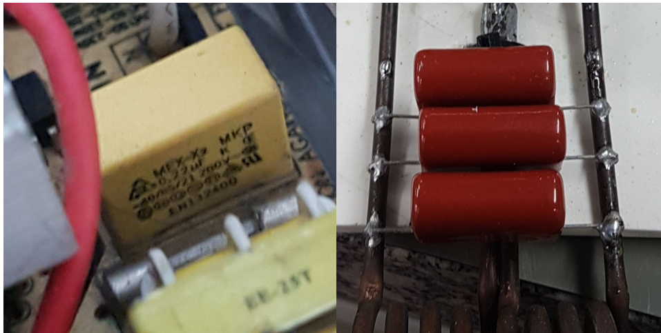
Figura 18: Na esquerda: capacitor MKP encontrado em uma fonte de computador. A direita: capacitores MKT como opção mais barata.
