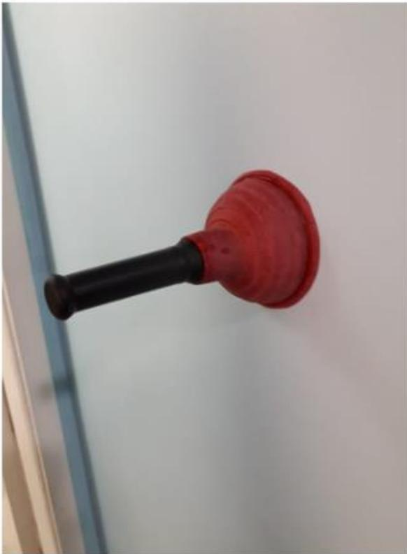
*Figura 13: Exemplo de teste do desentupidor em outras superfícies. Neste caso uma parede.*
