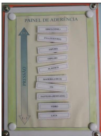
Figura 12: Segunda forma de classificação, ordenação de superfícies de acordo com a pressão sobre o desentupidor (ela foi colocada sobre a primeira com o auxílio de ímãs).
