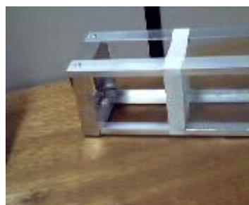
*Novo desenvolvimento visando uma lâmina quebra-cara grossa, larga e limpa. Faces de vidro contendo glicerina, montada sobre estrutura de alumínio.*
