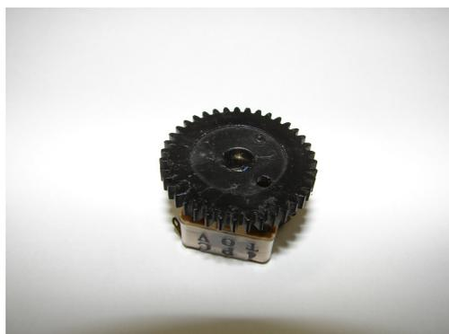
Acima vemos uma representação gráfica de um capacitor variável, quando você gira no sentido anti-horário temos que a área entre as placas diminuem, diminuindo assim a capacitância do capacitor, quando você gira no sentido horário aumenta-se a área entre as placas aumentando assim a capacitância que vão interferir na sintonização das ondas eletromagnéticas.
