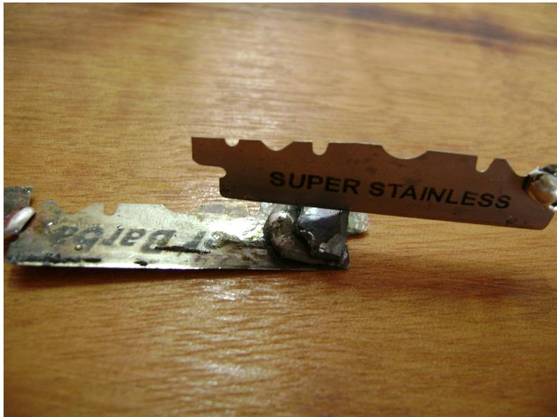
Fazendo este contato, entre o chumbo e a rocha, criamos um efeito diodo nesta ligação que comprovamos na figura a seguir utilizando um multímetro para testar esta propriedade e efetivamente em nosso rádio de galena:
