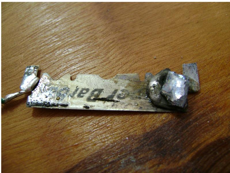
No lado direito temos o filamento de cobre conectado a lâmina de barbear, no lado esquerdo a pedra afundada no chumbo e o chumbo, por sua vez, fixo na lâmina.
