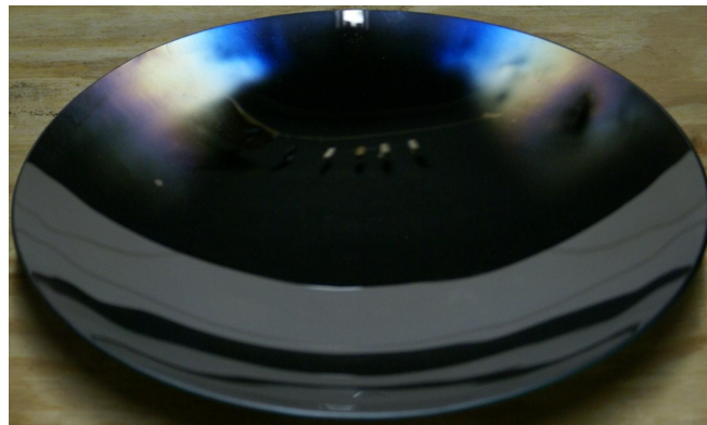
Figura 11: Espelho esférico obtido.
