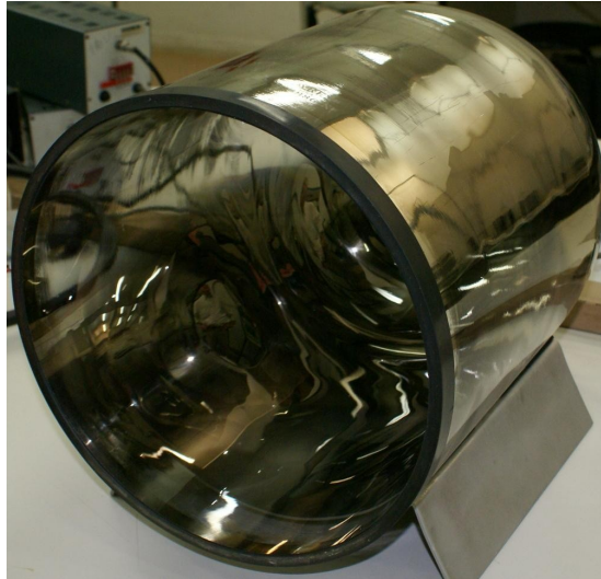
Figura 10: Campânula de vidro após o processo de deposição de alumínio
