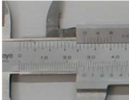
Figura 2: Escala de um paquímetro
