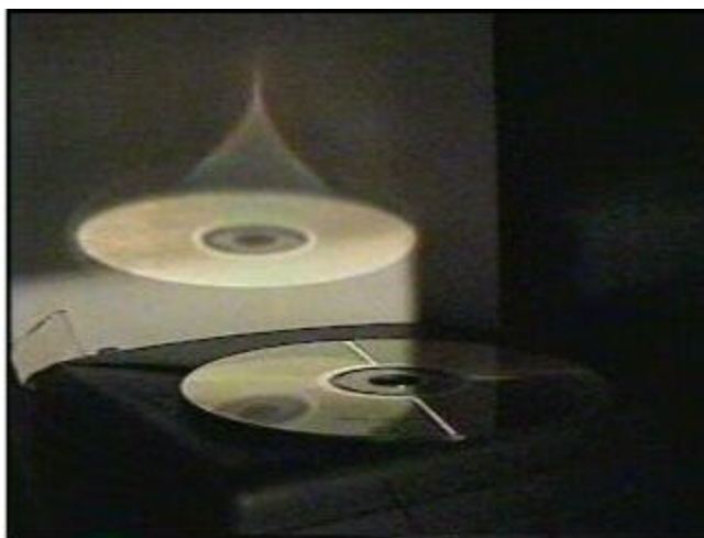
Figura 10: Difração sob luz branca sobre uma tela vertical, estando o CD horizontal e a lâmpada a 2,5 m de distância. O reflexo do CD no papel branco criou uma incrível ilusão de presença de um segundo CD que lançasse a figura por cima dele.
