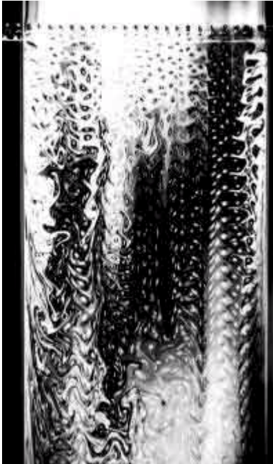
Figura 2: movimentos turbulentos causados por objetos inseridos no filme, imagem obtida de http://home.earthlink.net/~marutgers/science/turbulence/photos/slow.jpg
