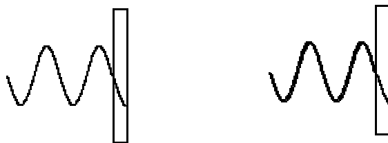
Figura 4: Reflexão construtiva. Reflexão da frente do filme em fase com a reflexão de trás do filme.
