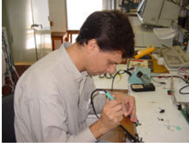
Figura 20- Soldagem do Anodo ao Resistor de 270 \Omega m
