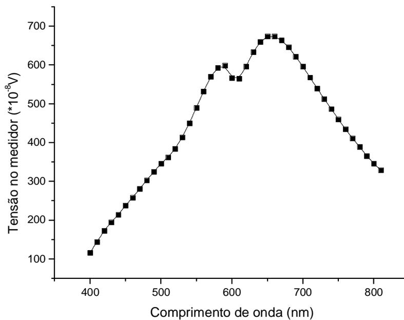
Como podemos notar, esse gráfico é a composição entre os gráficos da radiação do corpo negro e da resposta da rede de difração, conforme o esperado. Para se minimizar o erro na leitura, foi feita uma pré-verificação dos valores, de modo a ajustar o maior valor medido ao fundo da escala. Esse
