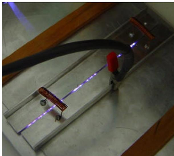
**Figura 10** – Distribuição homogênea das faíscas na cavidade. Note o plasma que ocorre concomitantemente.
