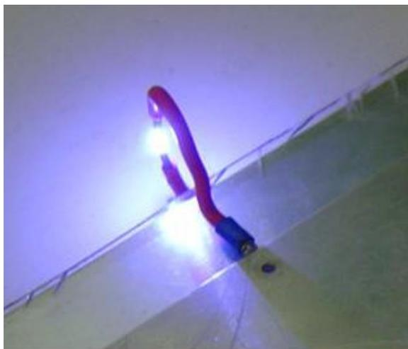
**Figura 7** – Dois fios com pontas trabalhadas (lixadas) servindo como *spark gap*.
