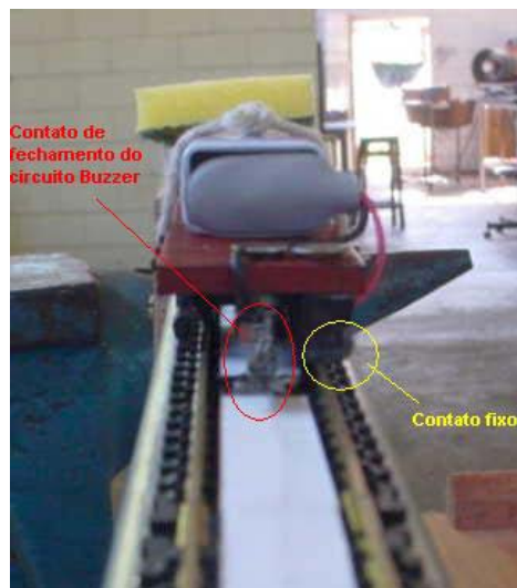
Figura 10: à direita o contato fixo entre a bateria e o buzzer a partir de um pedaço de esponja de aço e a barra do trilho. À esquerda os contatos para o fechamento do circuito buzzer.
