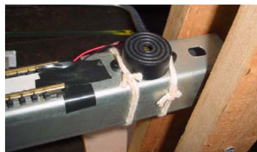
Figura 9: Buzzer fixado em uma das extremidades da barra de alumínio.
