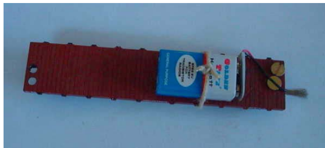
Figura 14: Construção final do trem, com a bateria e os dois parafusos que estabelecem contato com o buzzer.
