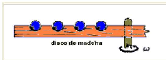
A força mínima para vencer os obstáculos (escavados) é a mesma para as 4 posições. Cada bolinha, devido à sua posição ( $r$ ), necessita de um conveniente  $\omega$  para atingir tal força mínima.
