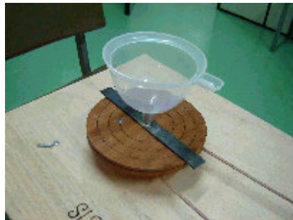
Figura 3: Experimento do líquido em rotação (espelho parabólico).
