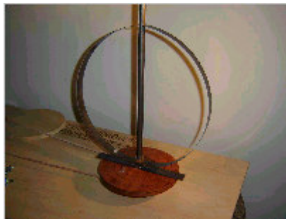
Figura 2: Experimento do aro flexível (achatamento da Terra).
