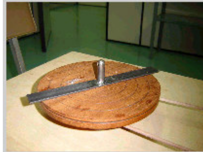
Figura 7: Base do experimento “força elástica como resultante centrípeta”.
