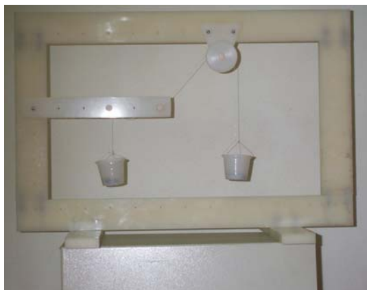
Figura 5: Montagem com a barra 6F e roldana
