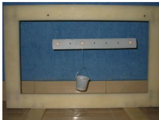
Figura 9: Aplicação do equilíbrio de torques
