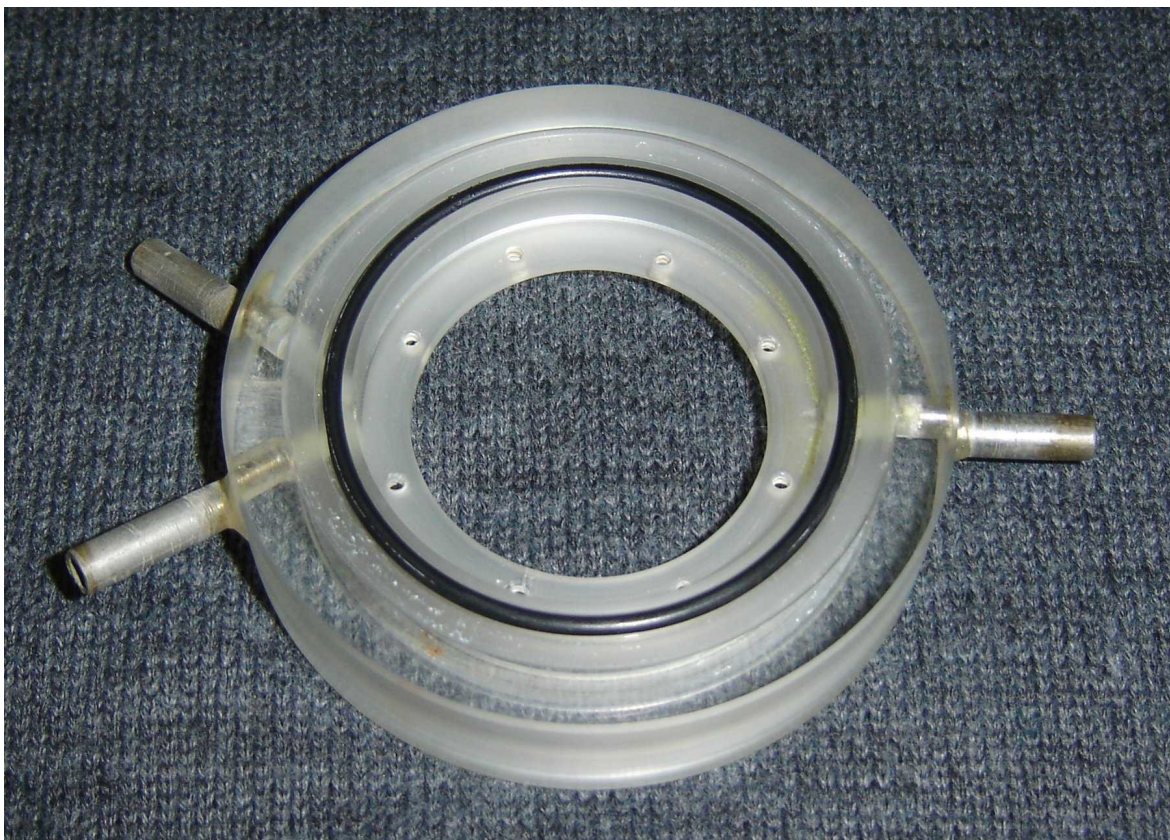
Figura 3: Peça principal da célula eletrolítica, usinada em acrílico
