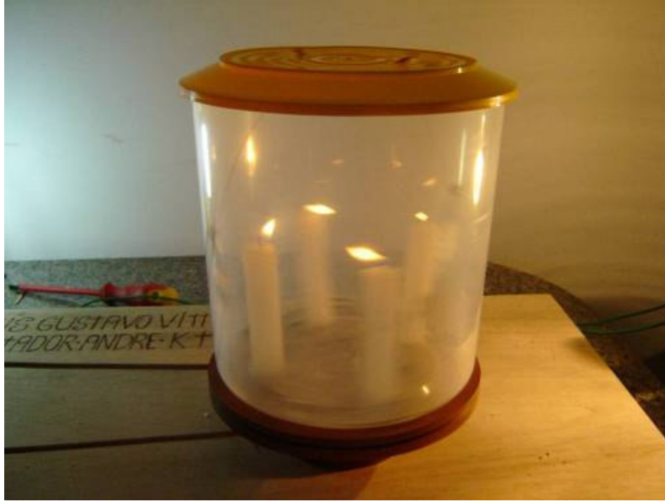
Fig. 8 – Aparato com as chamas inclinadas para o centro e os pêndulos inclinados para fora nas primeiras montagens.
