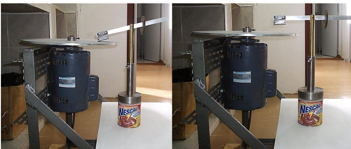
Figura 7: Levitação do ímã com VARIAC em 17,5V e contrapeso em 47,5mm.
