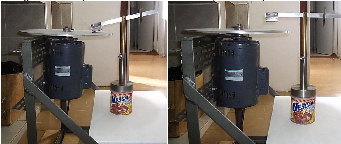
Figura 5: Levitação do ímã com VARIAC em 12,5V e contrapeso em 98mm.
