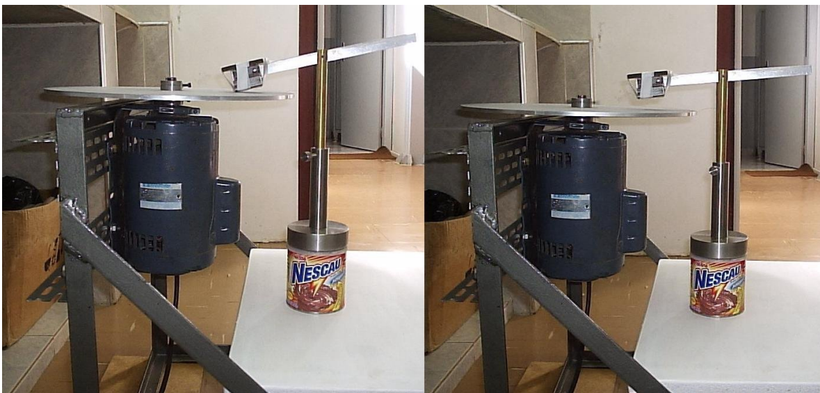
Figura 9: Levitação do ímã com VARIAC em 30V e contrapeso em cima do ímã.
