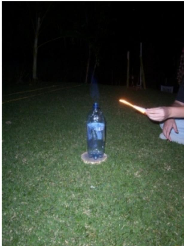
Figura 5.1: Imagem do jato de álcool em combustão, mostrando a garrafa usada.
