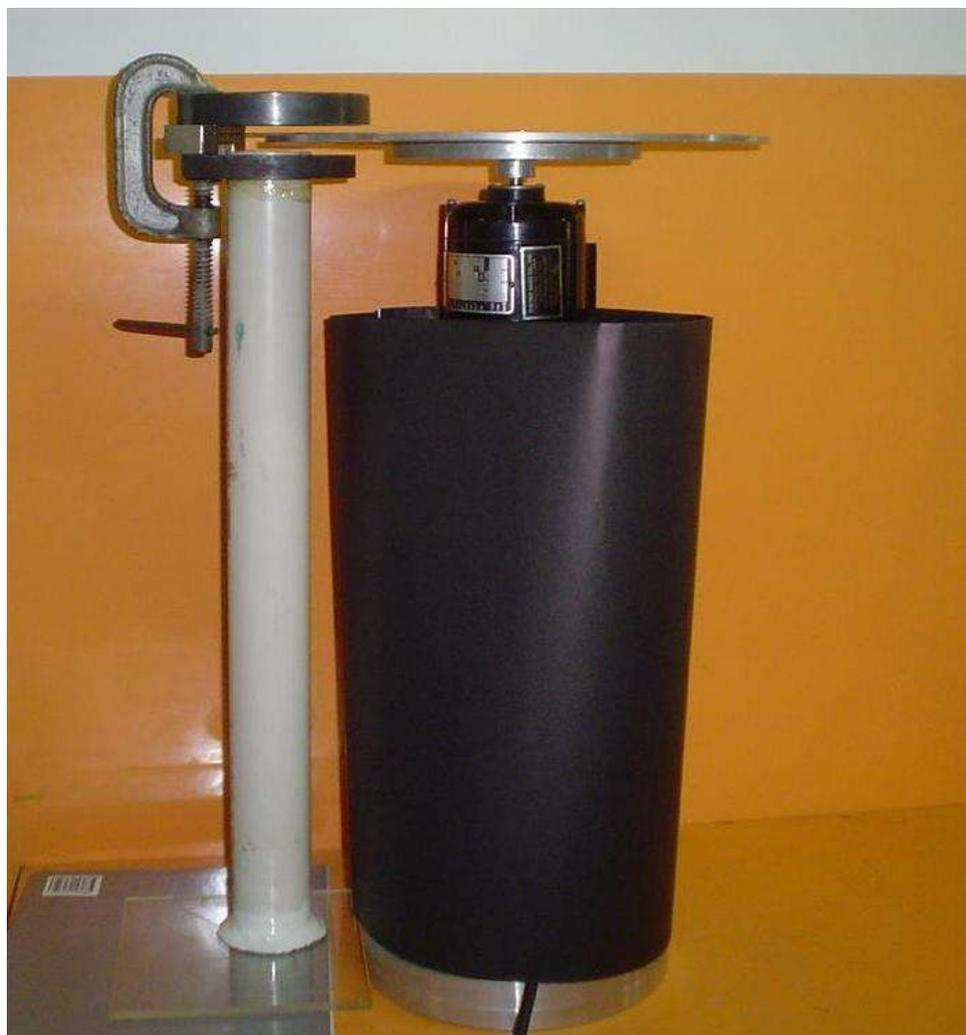
*Figura 22 Ímãs utilizados no freio magnético. O cano de PVC no qual os ímãs estão apoiados tem 50 mm de diâmetro.*
