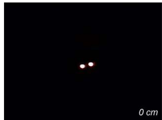
Figura 13(a): Projeção do feixe de luz, para a lente posicionada em sua distância focal (300 mm=0 cm).
