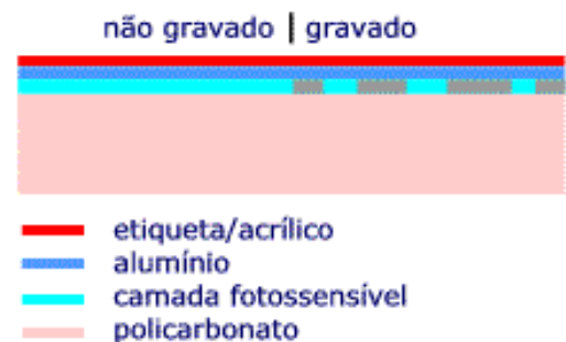
Figura 21: Esquema básico de um CD gravável.
