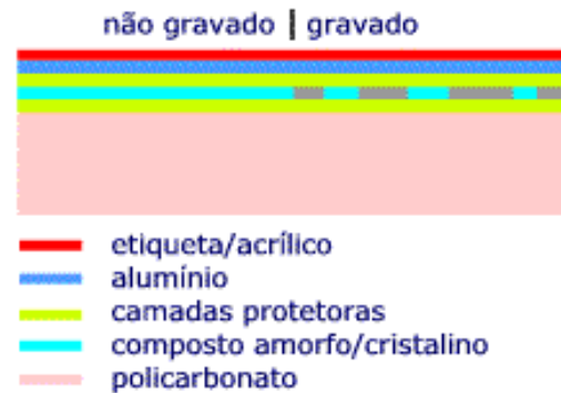
Figura 22: Esquema básico de um CD regravável.
