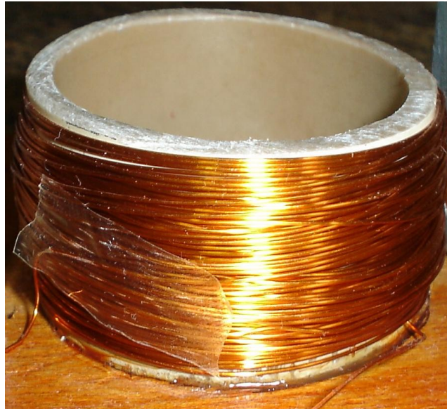
Figura 2: Detalhe de uma bobina utilizada na construção do motor. A bobina é constituída de um cano de PVC enrolado por fio de cobre.
