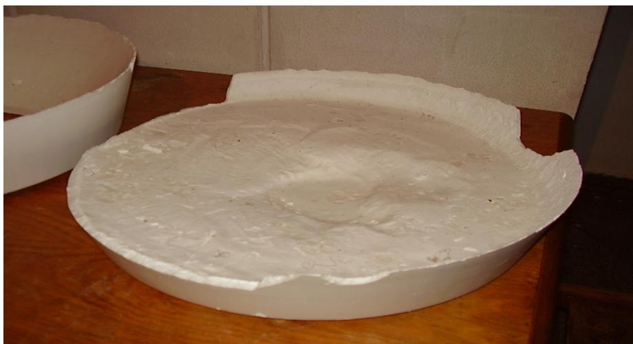
Fig. 7: Parabolóide de gesso solidificado fora do ponto de consistência.
