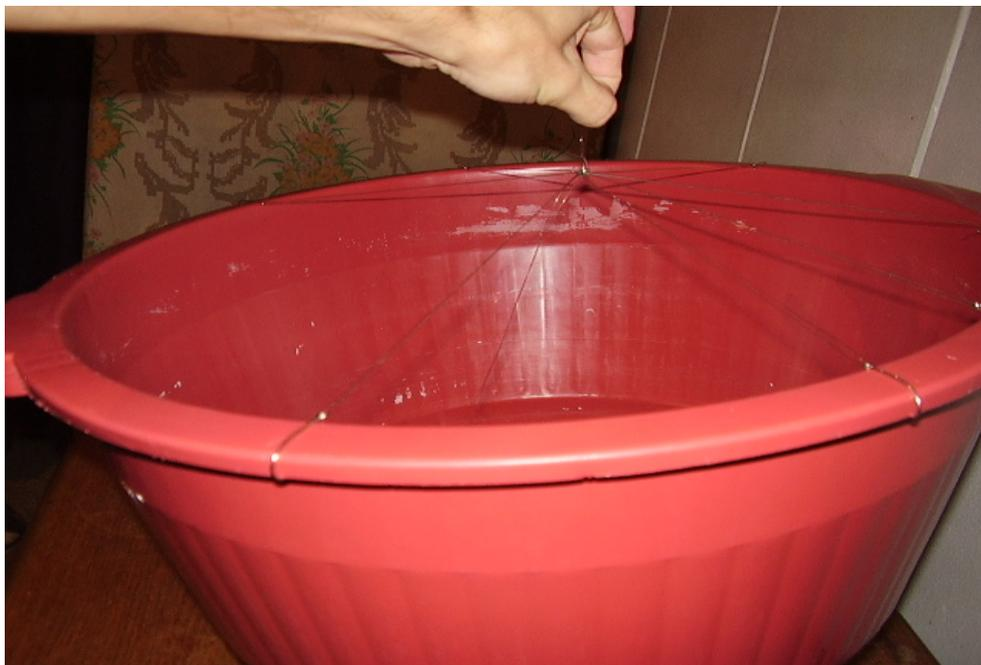
Fig. 5: Bacia com as alças de anzol responsável pela produção do contra-molde parabolóide de gesso.
