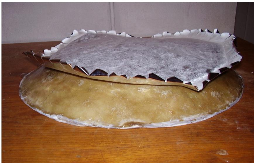
Fig. 13: Plástico filmado sobre o molde parabolóide para ser esticado com as fitas adesivas.
