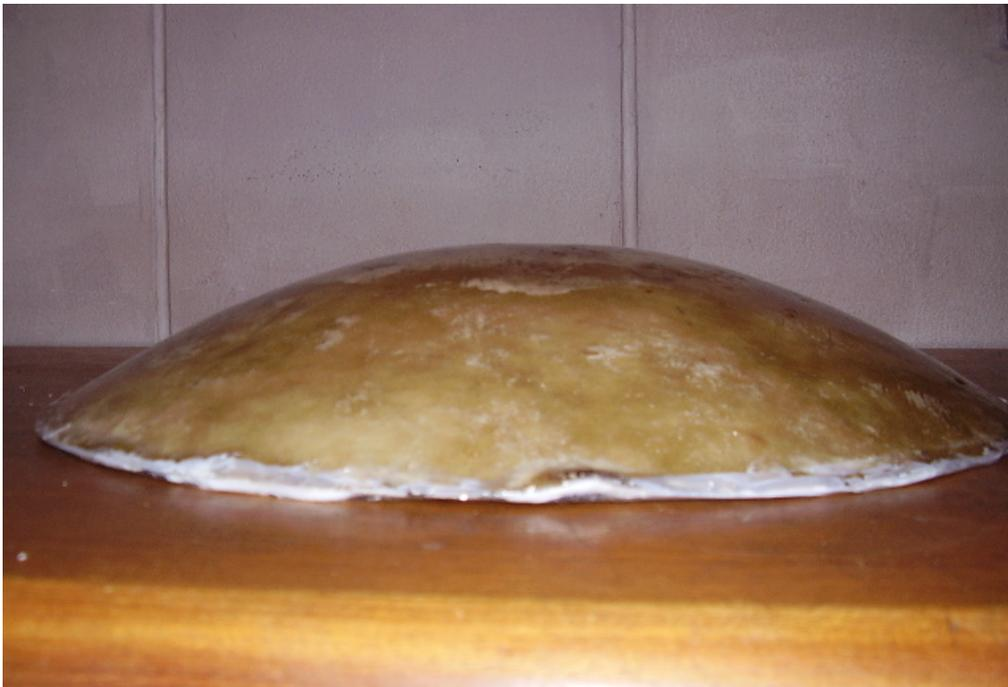
Fig. 10: Molde parabolóide de fibra de vidro e resina.
