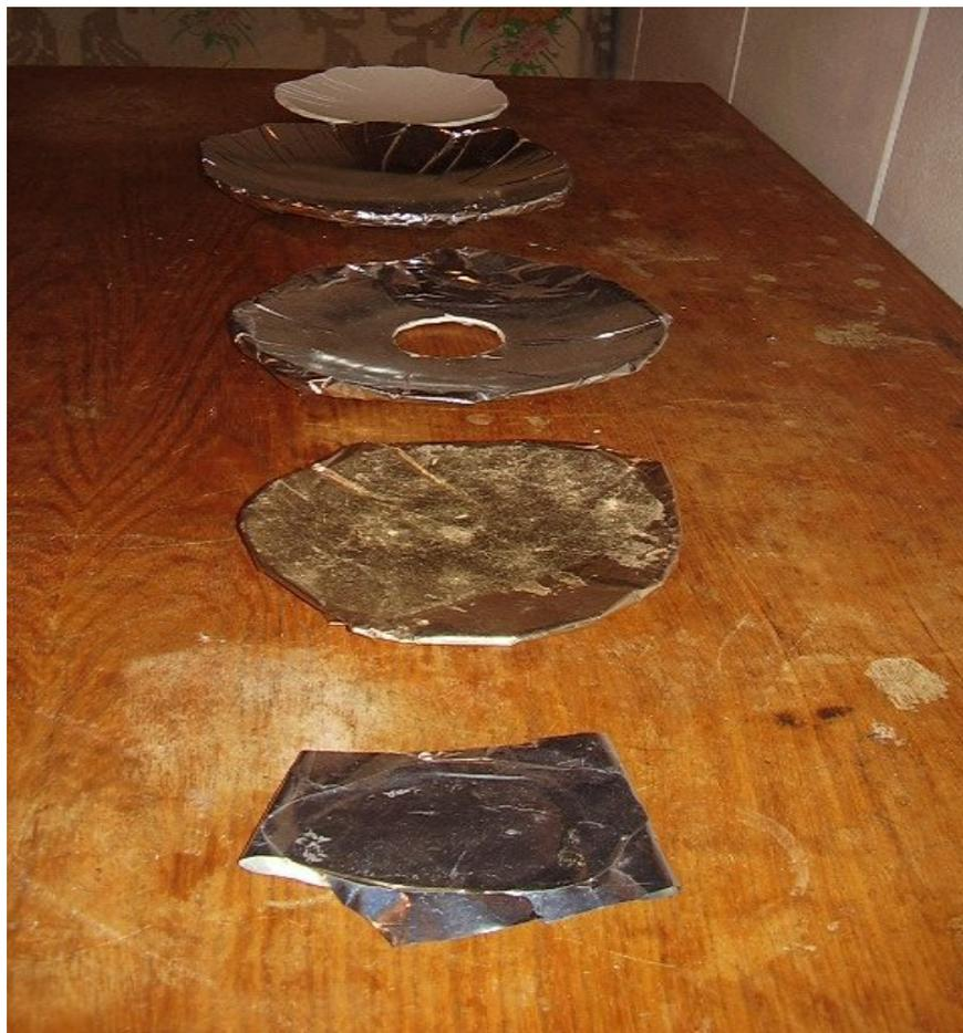
Fig. 1: Testes de adesão do papel laminado sobre superfícies planas e curvas.
