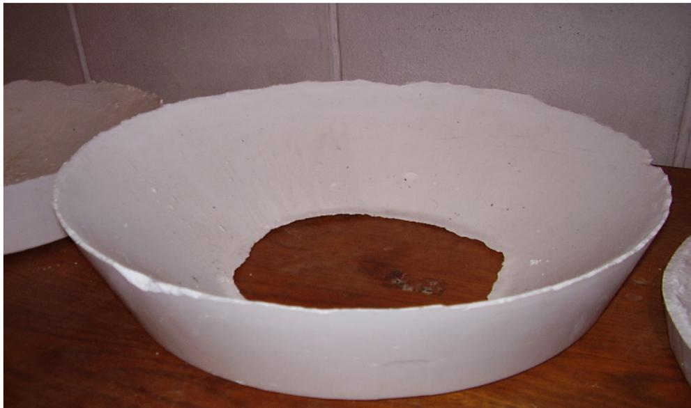
Fig. 8: Parabolóide de gesso solidificado em rotação muito rápida.
