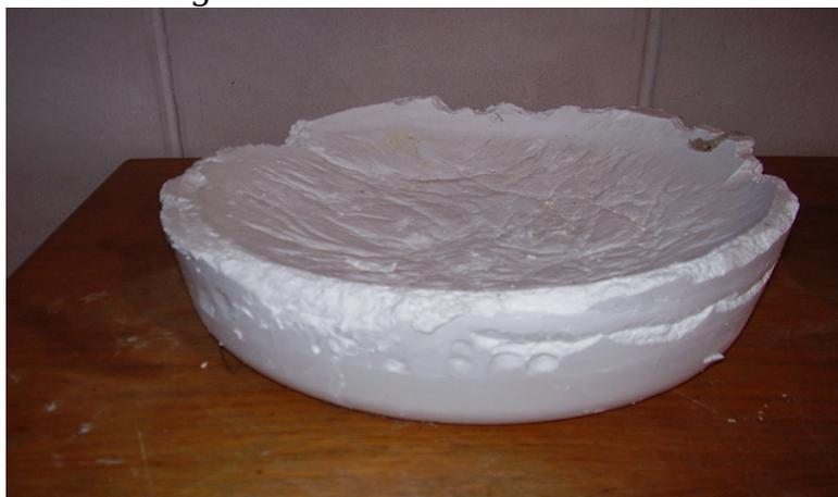
Fig. 6: Parabolóide de gesso solidificado fora do ponto.
