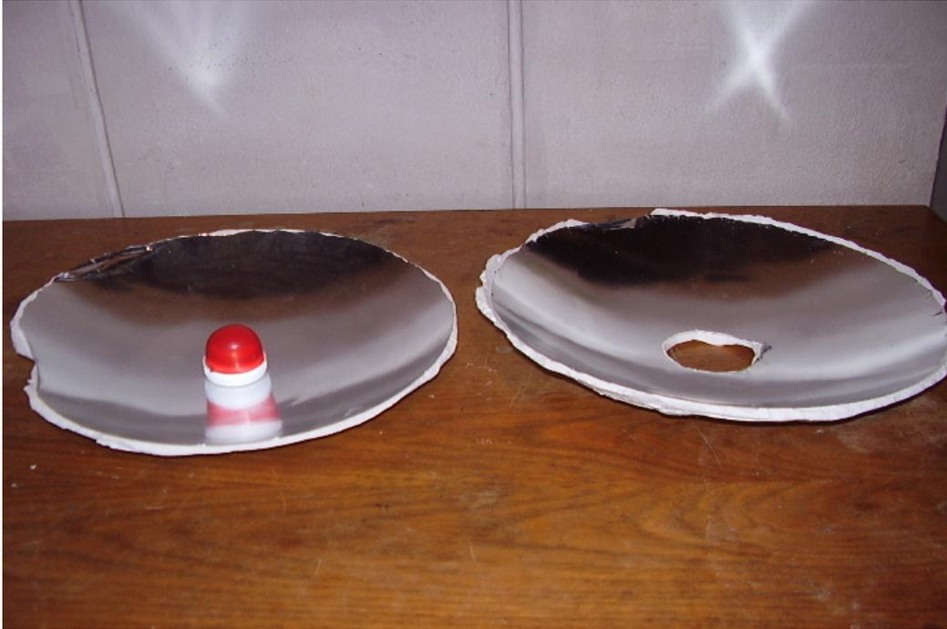
Fig. 3 : Espelhos côncavos produzidos sobre um globo rígido onde se esticou o plástico raiado.
