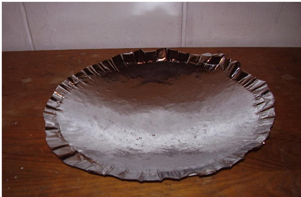
Fig. 15: Espelho parabolóide rugoso pois a superfície do molde não foi polida.
