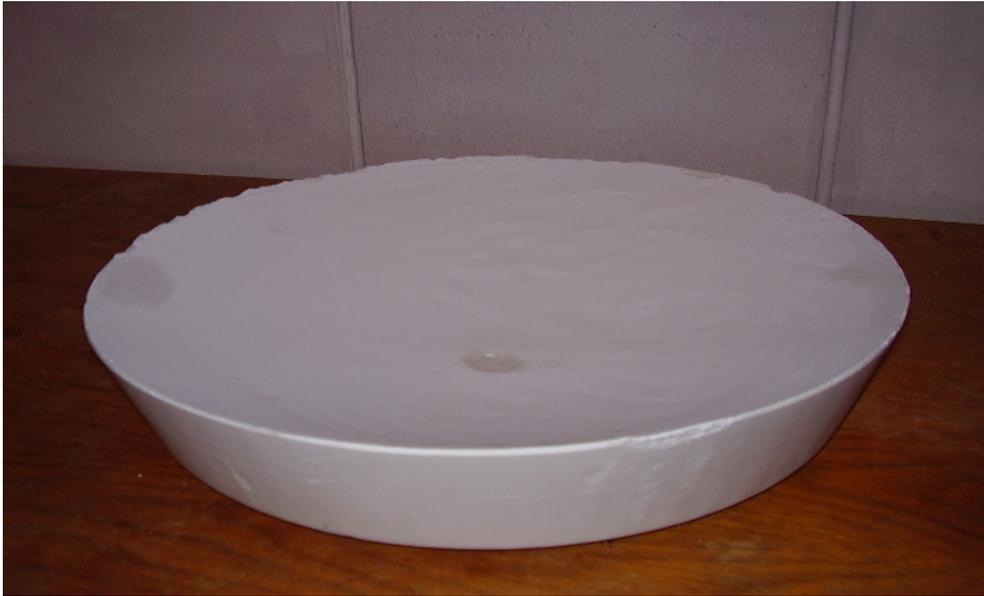
Fig. 9: Parabolóide de gesso construído observando qualitativamente a Eq. 6.
