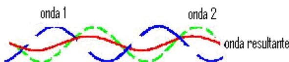
**Figura 7:** Interferência parcial de duas ondas
