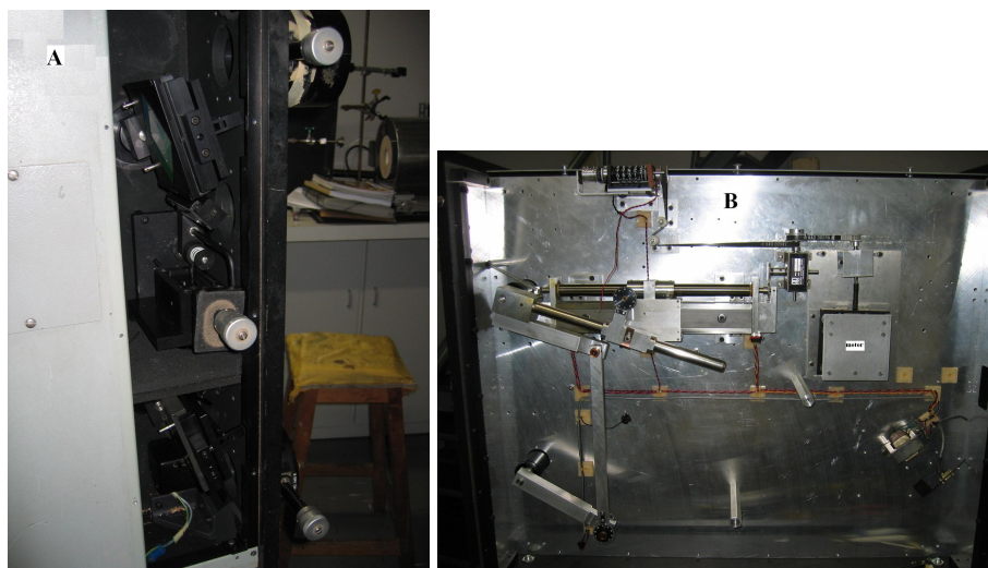
Figura 11: Foto mostrando A as duas grades de difração, B a parte mecânica do espectrometro, com indicação da posição do motor
