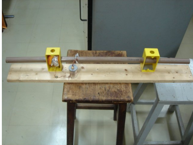
Figura 12 – Gerador de PVC montado.
